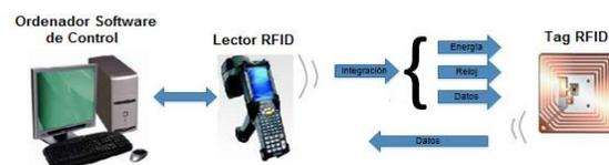
Figura I.2 Componentes de un sistema RFID. [3]
