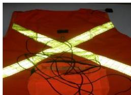
**Figura II.19** Acoplamiento de la antena GLONASS al chaleco.
