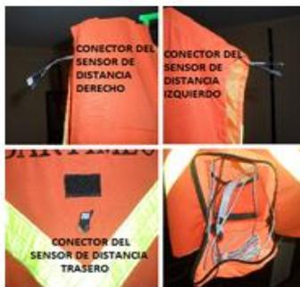
**Figura II.18** Acoplamiento de conectores y piezas de acrílico transparente en el chaleco.
