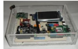
Figura II.12 Colocación de la tarjeta de control en la caja de acrílico transparente.
