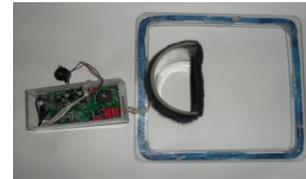
**Figura II.20** Ensamblaje del soporte de la antena RFID.
