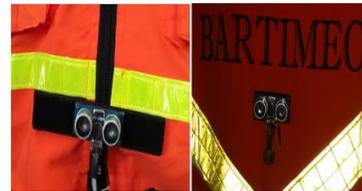
**Figura II.21** Colocación de los sensores de distancia sobre el chaleco.
