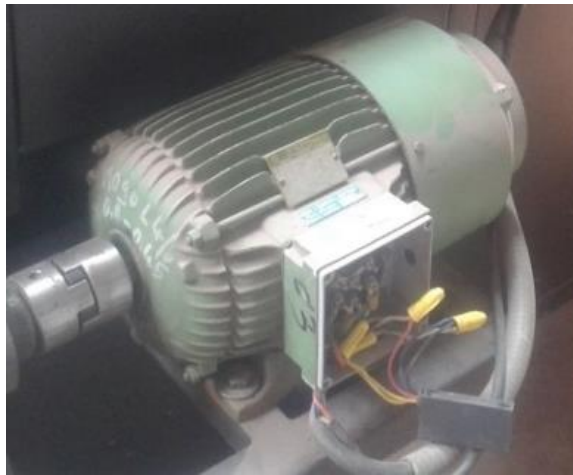
Figura 2. 32 Motor para el desplazamiento de la cámara de vacío.
