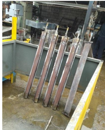
Figura 2. 18 Flautas de gas extraídas de la cámara de temperatura
