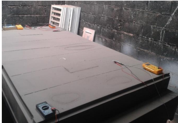
Figura 3.5 Medición de la temperatura uniforme en toda la cámara.
