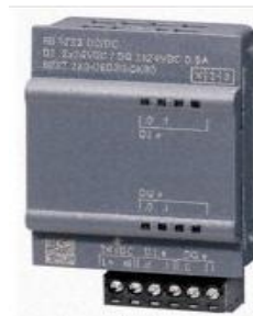
Figura 2. 24 SB1221 Signal board 1 AI para Termocupla tipo J ó K.
