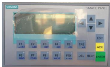
Figura 2. 25 Pantalla SIEMENS KP300 Basic mono PN
