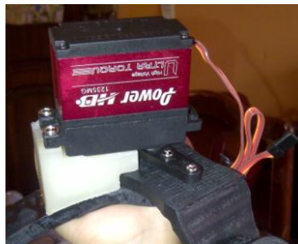
Figura 3. 23 Montaje de Servomotor 3.
