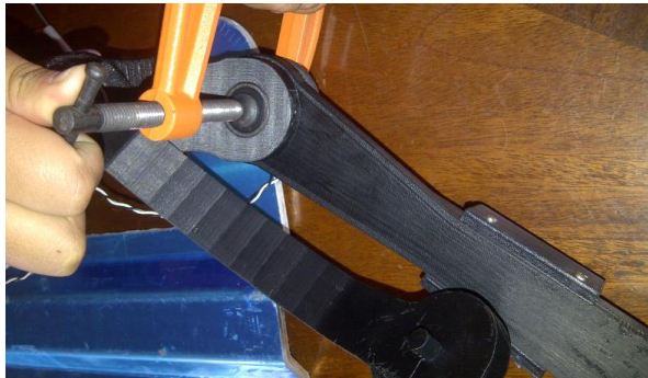
Figura 3. 19 Ajuste de rodamientos para incrustar los ejes de servomotores.
