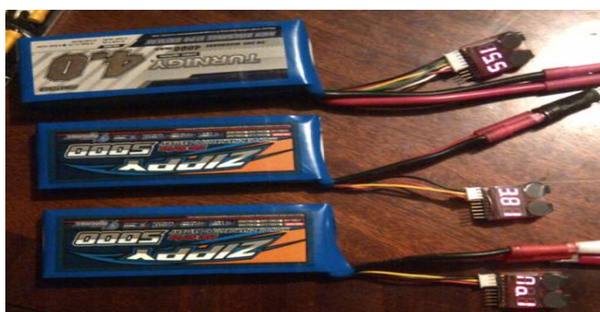
Figura 4. 18 Medición de voltaje en baterías de Li-po
