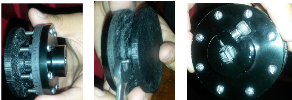
Figura 3. 20 Ajuste de polea para Servomotor 1.
