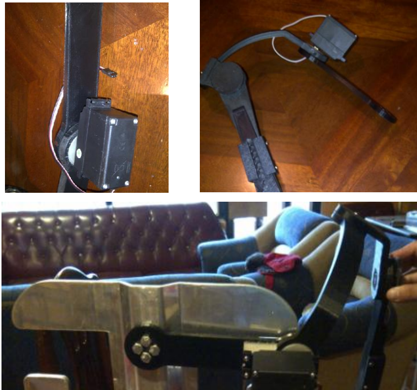
Figura 3. 22 Montaje de Servomotor 2.
