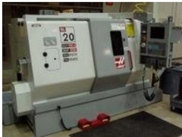
**Figura 0-8 Torno CNC**<sup>31</sup>
