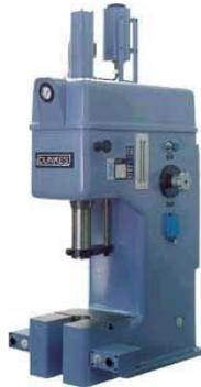
Figura 0-3 Prensa neumática.<sup>39</sup>
