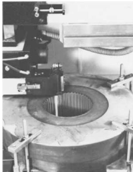
**Figura 0-15 Mecanizado electroerosivo por hilo de un troquel de acero templado y revenido.**
