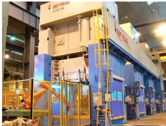
**Figura 0-7 Prensa de palanca articulada<sup>43</sup>**
