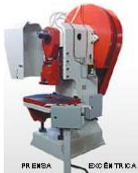
**Figura 0-5 Prensa excéntrica de simple efecto<sup>41</sup>**
