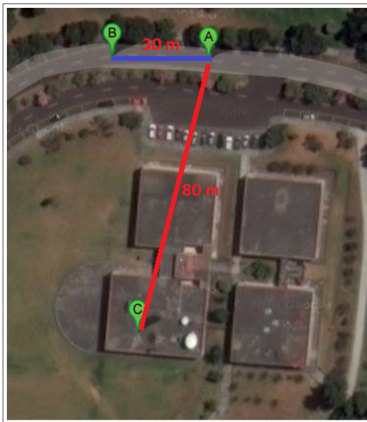
Figura 53: Distribución de los nodos (A y B), y el Gateway (C) en exteriores.
