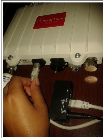
Figura 65: Insertar el cable ethernet.
