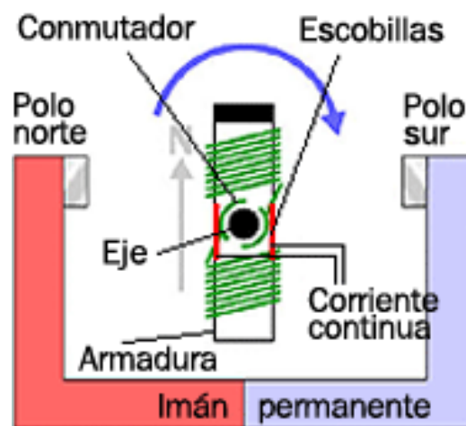
Figura 2.0.13: Principio de funcionamiento de un motor eléctrico
