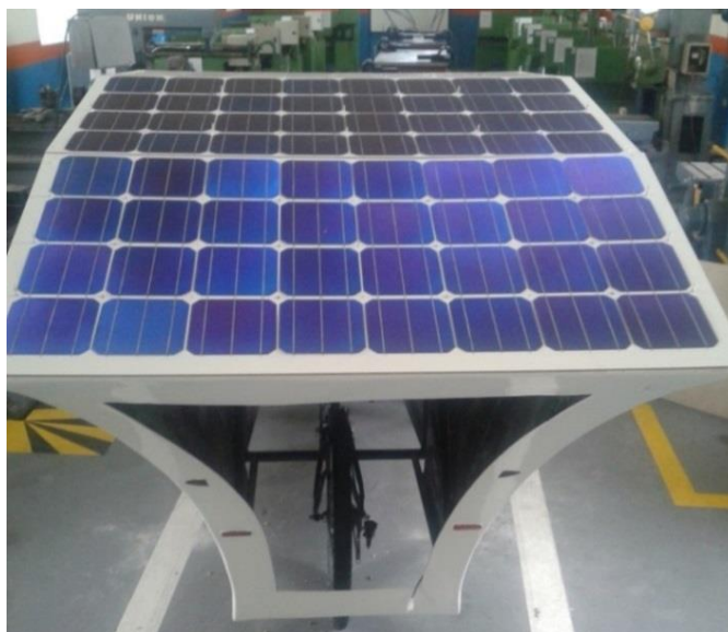
Figura 4.0.2: Panel fotovoltaico instalado
