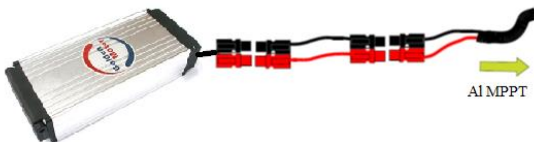
Figura 4.0.24: Conexión aislada de baterías
