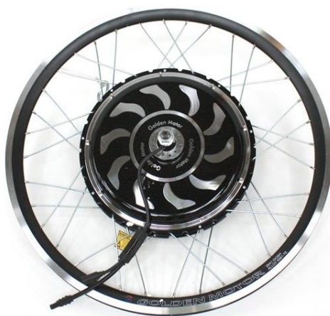
Figura 4.0.17: Motor Magic Pie 3 en una rueda
