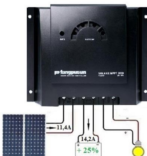
Figura 2.0.2: MPPT (Seguidor del punto de máxima potencia)
