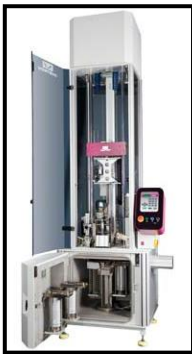
Figura 1.6: Torre de impacto vertical
