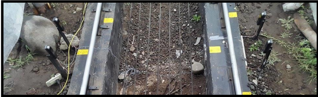
Figura 3.26: Distribución de los sensores fotoeléctricos
