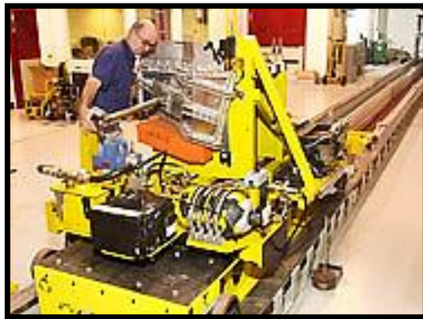
Figura 1.10: Estructura Mecánica del banco de pruebas
