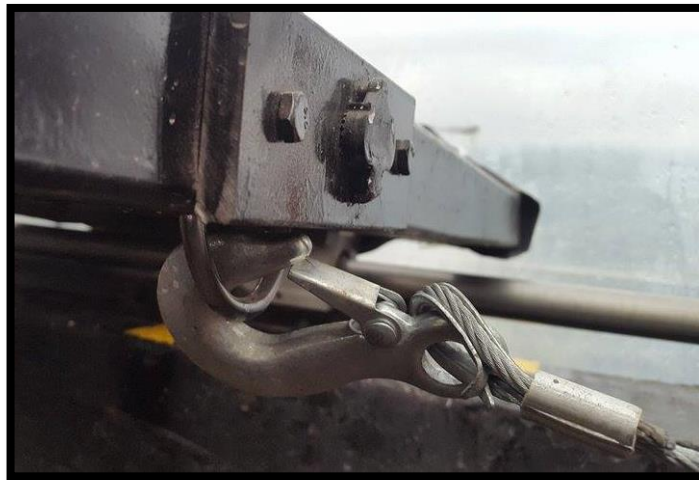
Figura 3.20: Sujeción del trineo móvil mediante la grúa eléctrica.
