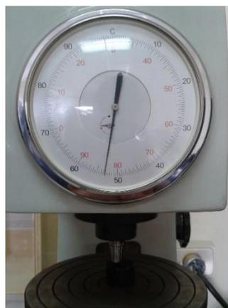
**Figura 3.35. Durómetro Rockwell.**
