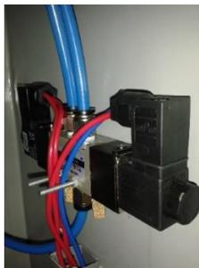
**Figura 3.5. Electroválvula de doble pilotaje.**
