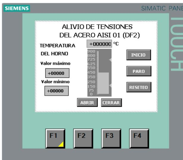
**Figura 3.54. Alivio de tensiones del acero AISI 01 (DF2).**
