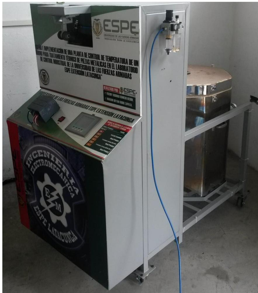
**Figura 3.17. Planta de tratamientos térmicos para piezas metálicas.**
