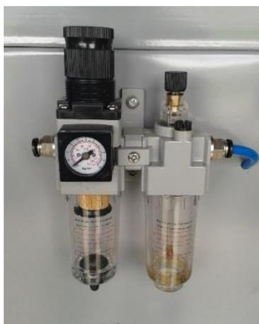
**Figura 3.4. Unidad de mantenimiento neumática.**
