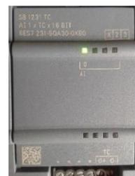
**Figura 3.30. Módulo de entrada analoga para termocupla tipo J o K (SB 1221 TC).**
