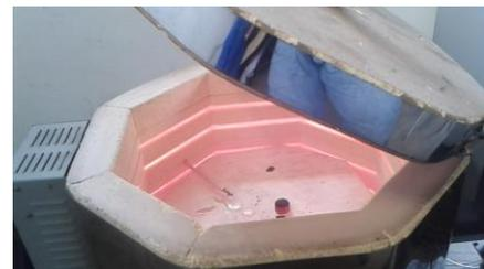
**Figura 3.29. Termocupla dentro del horno ubicada junto a la probeta que está siendo tratada.**
