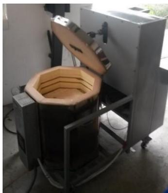
**Figura 3.34. Horno para tratamientos térmicos para aceros en funcionamiento.**
