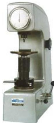
**Figura 1.21. Durómetro Rockwell.**
