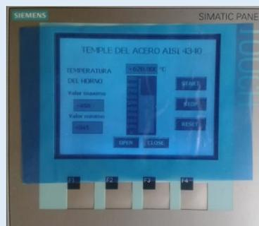
**Figura 3.32. Vista de la pantalla HMI leyendo la temperatura real del proceso.**
