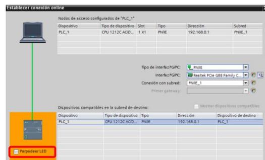
**Figura 3.24. Verificación de la comunicación Ethernet.**
