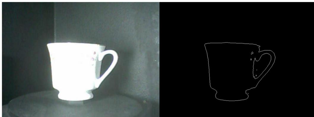
**Figura 3. 20 Imagen original de la taza y aplicada el filtro de Canny durante el proceso**
