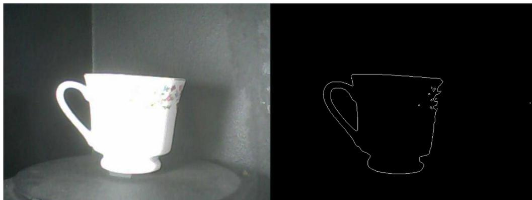
**Figura 3. 18 Imagen original de la taza y aplicada el filtro de Canny al inicio del proceso**
