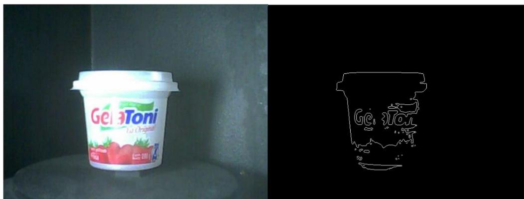
**Figura 3. 14 Imagen original del frasco de plástico y aplicada el filtro de Canny al inicio del proceso**
