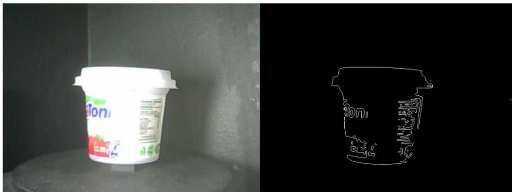
**Figura 3. 16 Imagen original del frasco de plástico y aplicada el filtro de Canny durante el proceso**
