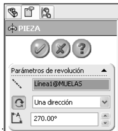
FIG.4.31 Pantalla proceso de revolución
