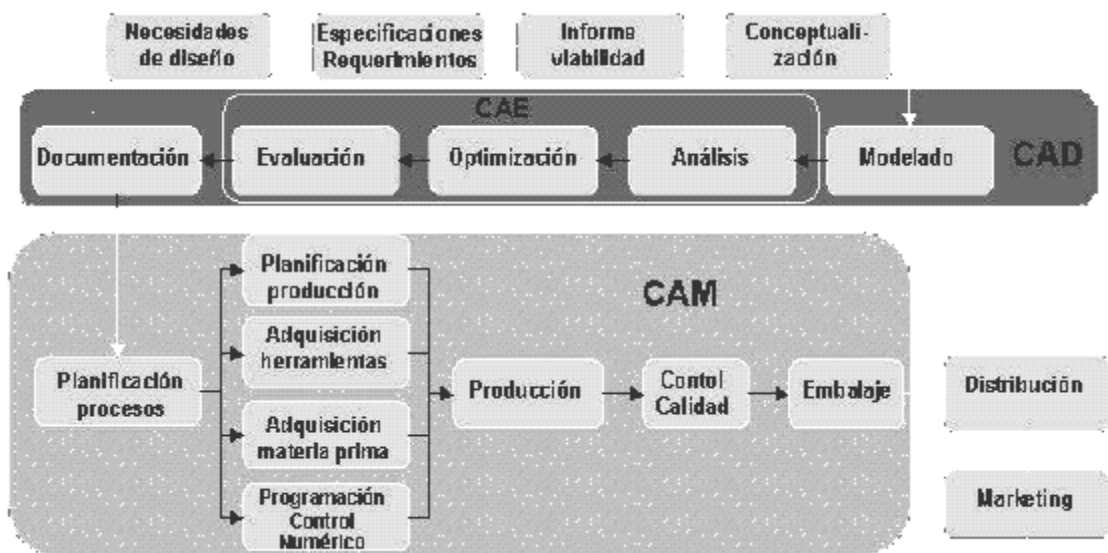
Fig.2.2 Estructura de los procesos de manufactura cae/cad/CAM
