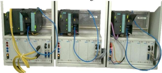
Figura 11. Conexión de cables Ethernet en el módulo de comunicación CP 343-1 Lean
