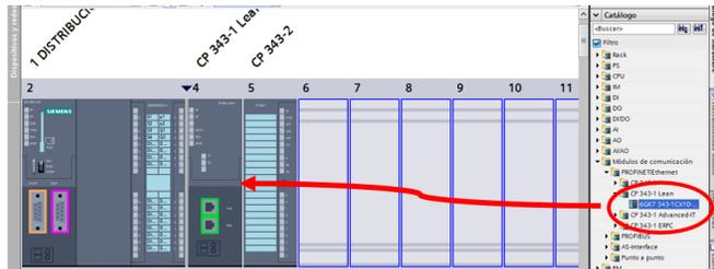
Figura 13. Configuración del módulo de comunicación CP 343-1 Lean en software TIA PORTAL V12
