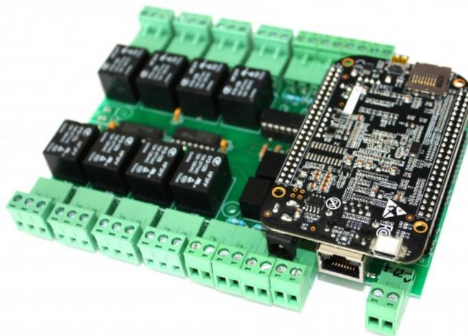
**Figura 2.55** Tarjeta BBB montada directamente.
