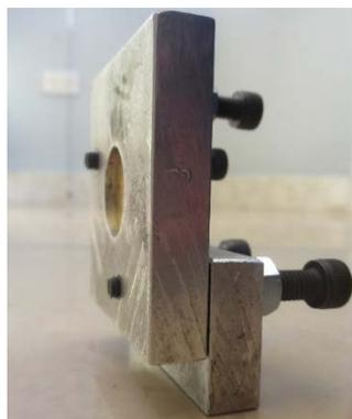
**Figura 3.16** Montaje soporte espejo eje X
