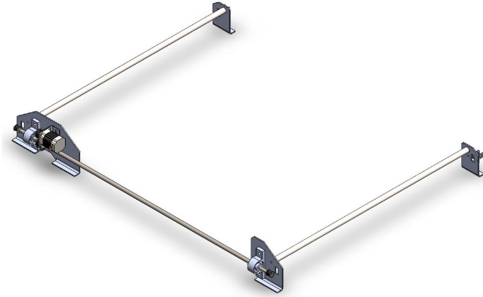
**Figura 2.31** Ensamble del Eje Y.
