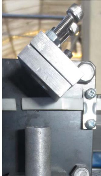
**Figura 3.17** Montaje soporte espejo cabezal láser.
