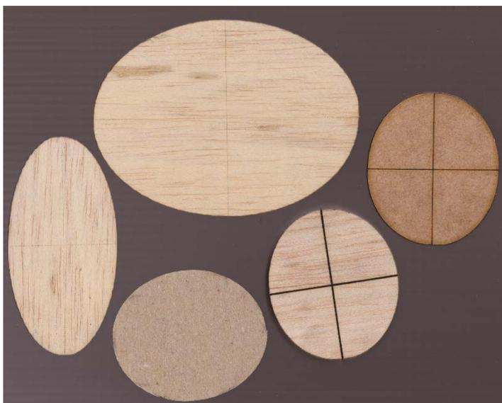
**Figura 4.6** Cortes de pruebas de precisión.
