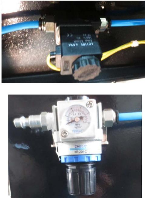
**Figura 3.30** Montaje del asistente de aire
