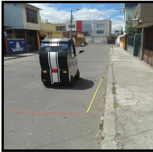
Figura 4. 16. Desplazamiento en prueba de frenos
