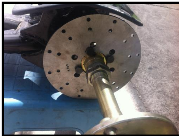
Figura 4. 6. Disco de freno adaptado al eje trasero
