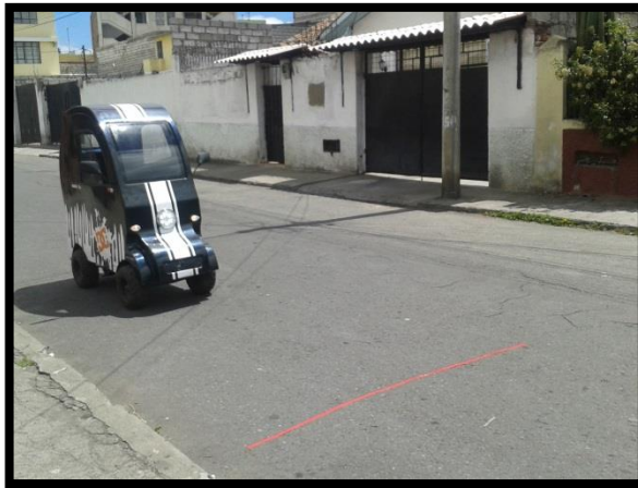
Figura 4. 15. Prueba de frenado a 30 km/h
