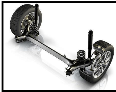
Figura 2. 15. Sistema de suspensión de ruedas con un mismo eje.
