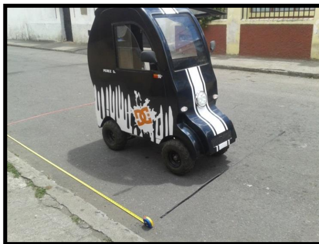
Figura 4. 17. Análisis de desplazamiento del mini auto en freno
