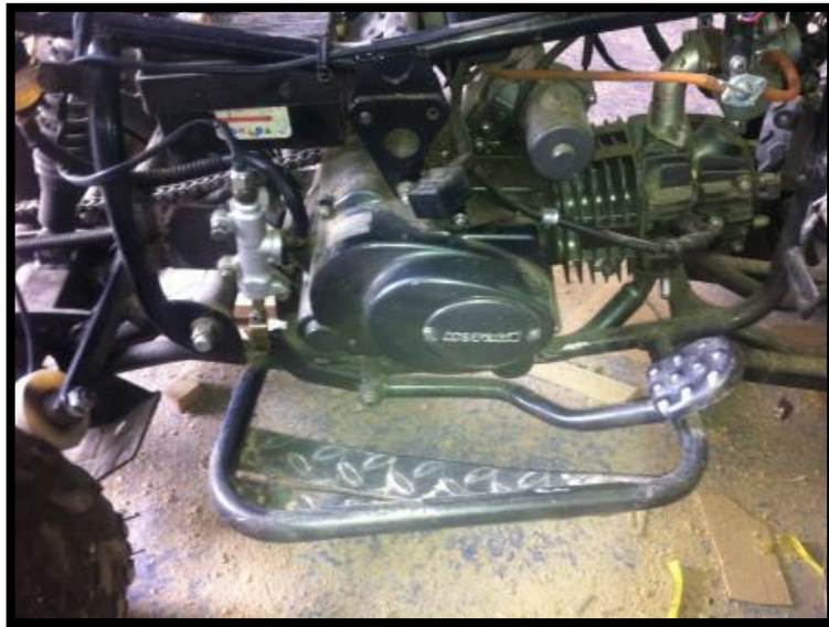
Figura 4. 7. Adaptación de un pedal para el freno
