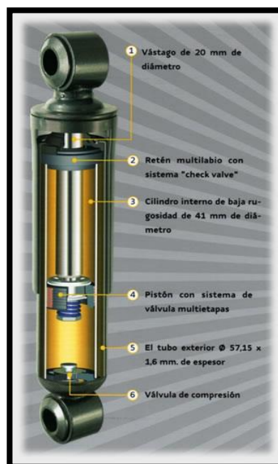
Figura 2. 14. Amortiguador hidráulico
