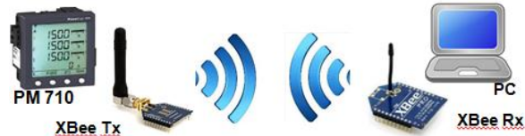
Figura 6: Estructura de la red
