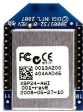
Figura 4: Vista posterior de los módulos XBee empleados
