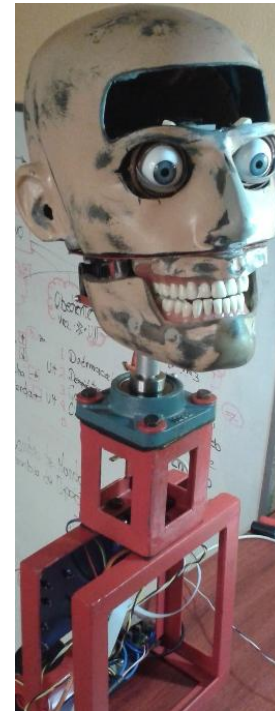
Ensamblaje de Comprobación de los Elementos Mecánicos.
