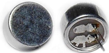
Micrófono – Transductores Electroacústico de Condensador
