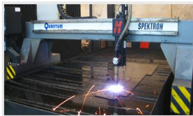
Figura 1.3: Corte de una lámina de acero para blindaje
