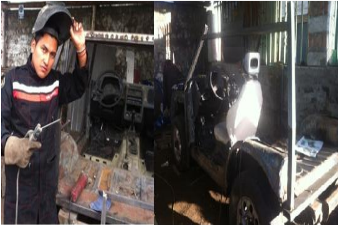
Figura 3.13: Soldadura de los parantes y travesaños
