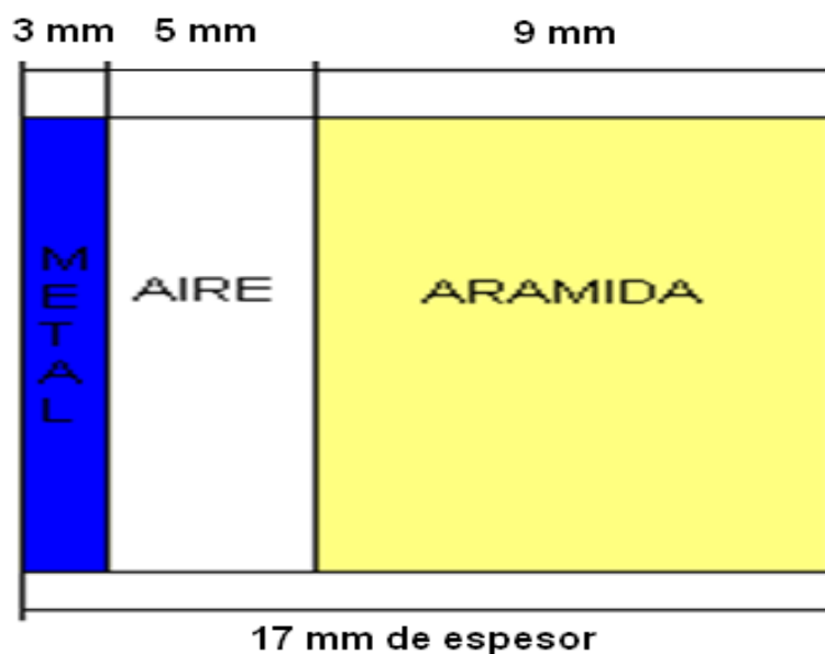
Figura 2.1: Representación esquemática de las capas del blindaje.
