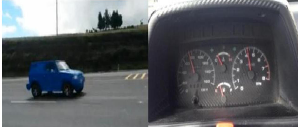
Figura 4.10: Velocidad máxima con inclinación en asfalto.
