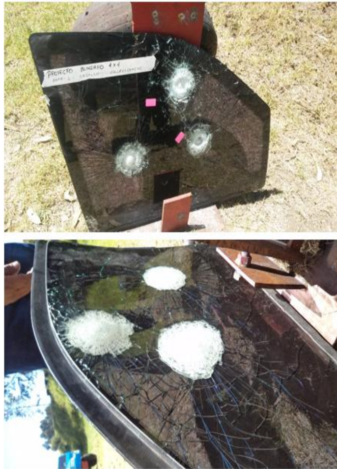
Figura 4.3: Resultados de la prueba vidrio blindado
