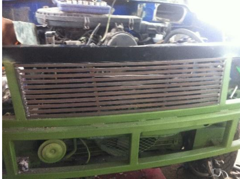
Figura 3.27: Persiana instalada con cuatro pernos
