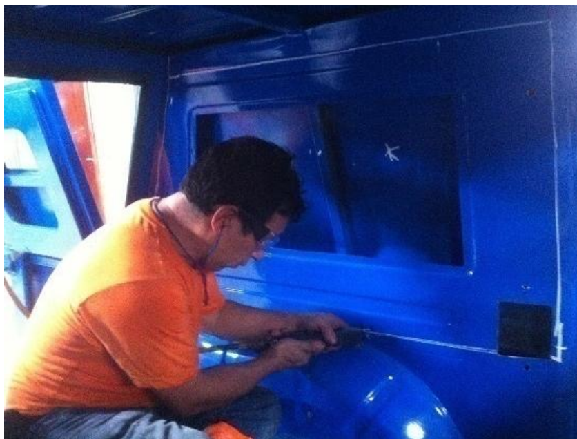
Figura 3.32: Corte para la instalación del kevlar
