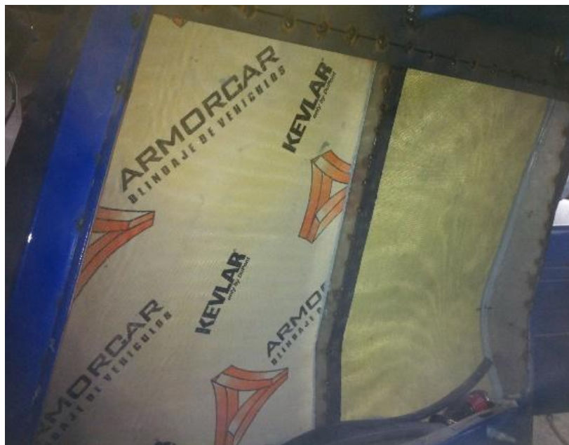
Figura 3.36: Portaequipaje blindado con kevlar y acero balístico
