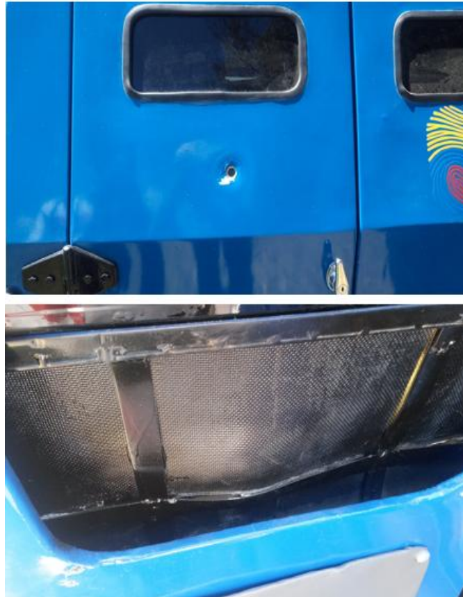
Figura 4.5: Prueba puerta blindada
