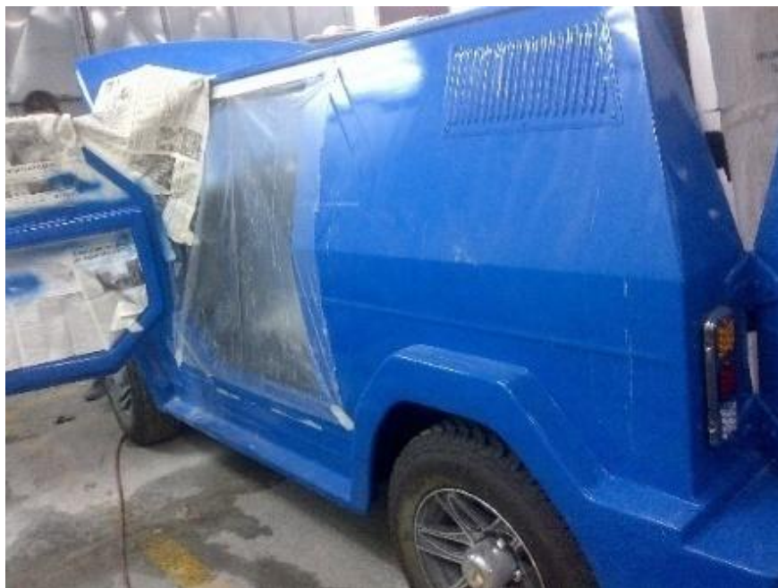
Figura 3.40: Vehículo forrado con plásticos y papel
