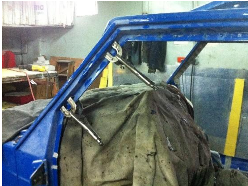
Figura 3.35: Sujeción del acero balístico con prensas
