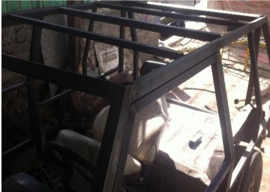
Figura 3.17: Travesaños del techo
