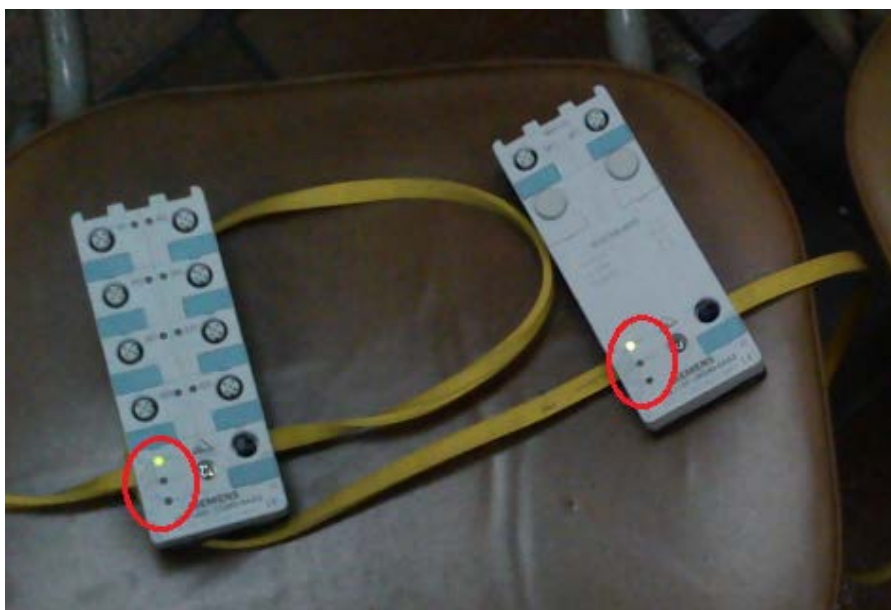
Figura 3.7: Esclavos AS-Interface direccionado correctamente.
