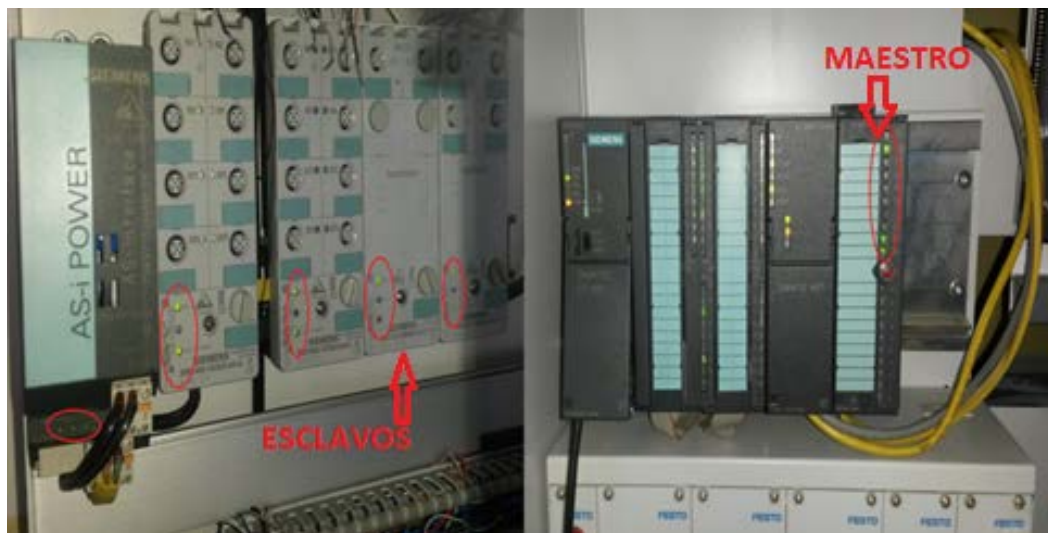
Figura 3.10: Fuente AS-Interface formando parte de la red.
