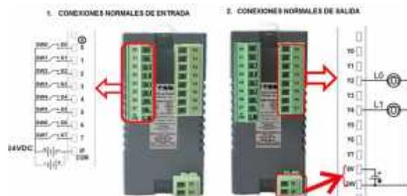
Figura 6. Módulos de expansión de entradas y salidas
