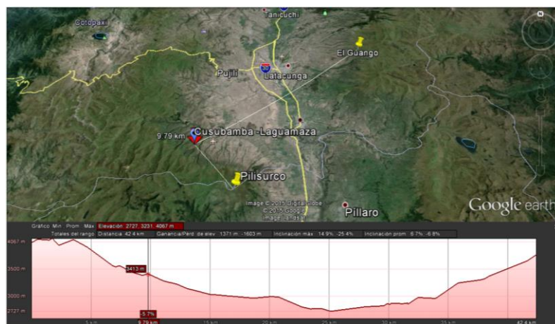
Figura 5.27: Perfil Geográfico BTS Pillisurco- Laguamaza- BTS El Guango
