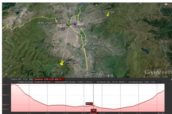
Figura 5.4: Perfil Geográfico BTS Pillisurco- Inchaipo- BTS Guango
