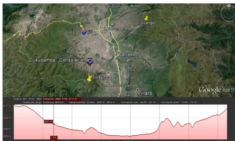
Figura 5.25: Perfil Geográfico BTS Pillisurco- Consolación- BTS El Guango
