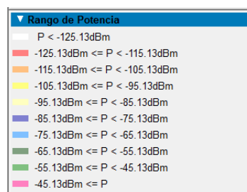
Figura 4.43: Rango de Potencias del Tx1 Guango con el modelo Deygout
