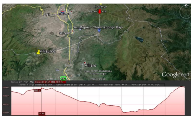
Figura 5.31: Perfil Geográfico BTS Pillisurco- Chambapongo Bajo- BTS El Guango
