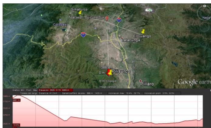
Figura 5.20: Perfil Geográfico BTS Pilisurco- Cuicuno Sur
