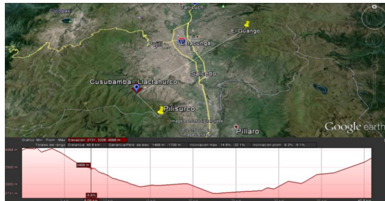
Figura 5.28: Perfil Geográfico BTS Pillisurco- Llactahurco- BTS El Guango
