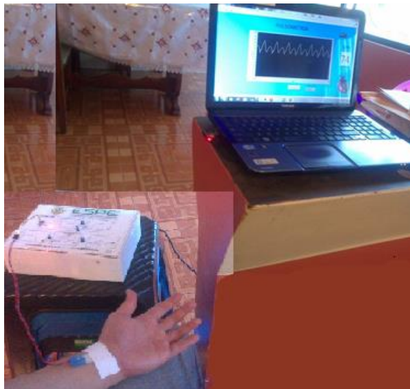
Figura 3.8. Valor y forma de onda de la frecuencia cardíaca mostrada en el HMI del circuito implementado.
