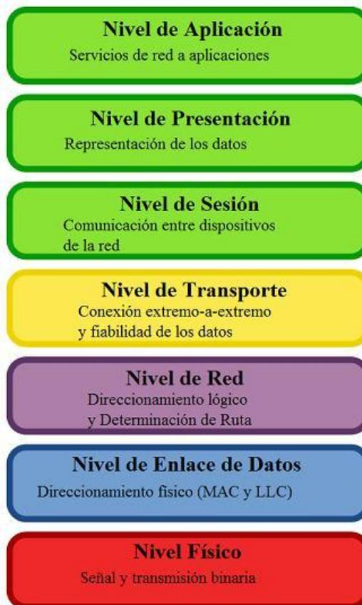
Figura 1.4 Capas del modelo OSI [11]
