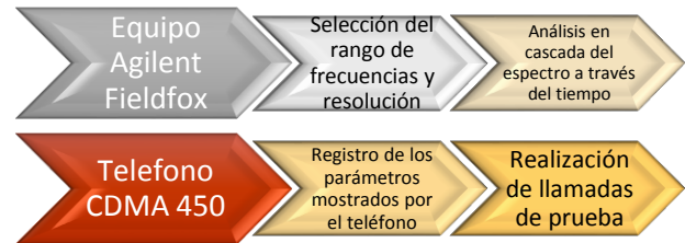
Figura 4. Diagrama de bloques de los elementos de la estación móvil y procedimiento de medición.
