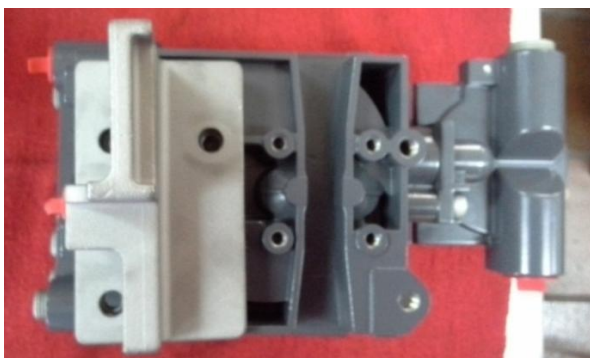
Figura 2.4 Alineación de la platina (Pt-001) en el Posicionador DVC6200
