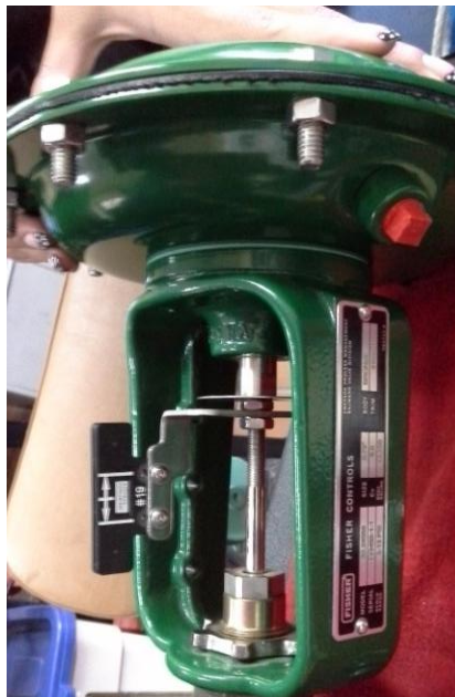
Figura 2.8 Conjunto de imán colocado en el vástago de la válvula Baumann 2400
