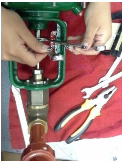
Figura 2.10 Fijación del conjunto de imán al vástago de la válvula
