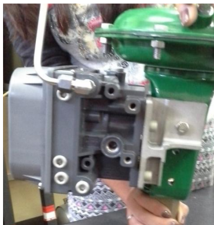
Figura 2.12 Posicionador DVC6200 montado en la válvula Baumann 24000. Vista lateral
