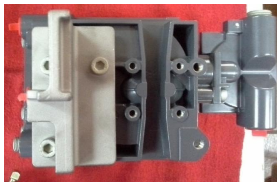
Figura 2.5 Fijación de la platina (Pt-001) en el Posicionador DVC6200
