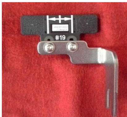
Figura 2.6 Fijación de la platina (Pt-002) en el imán (Im-001)
