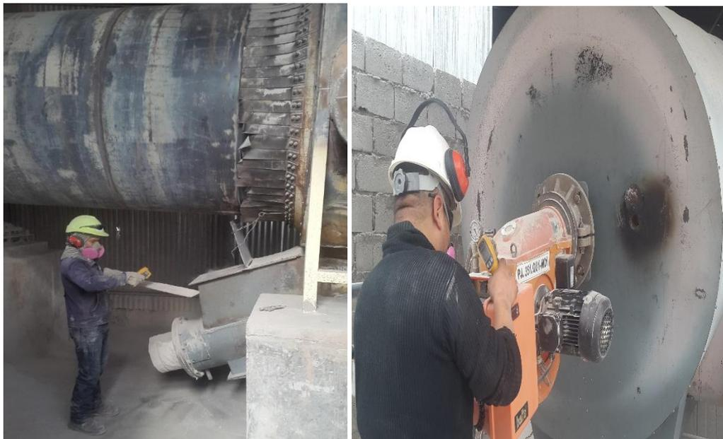
**Figura 3.2. Medición y control manual de temperatura.**
