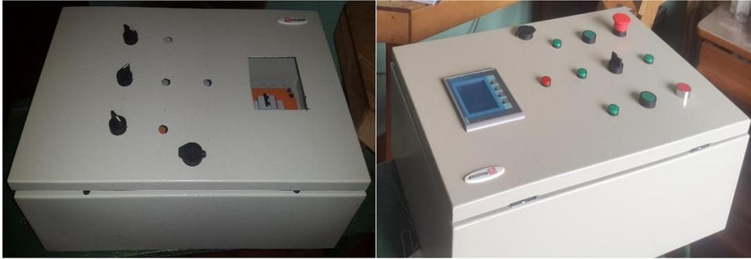
**Figura 2.26. Elementos fijos en la parte frontal del tablero.**
