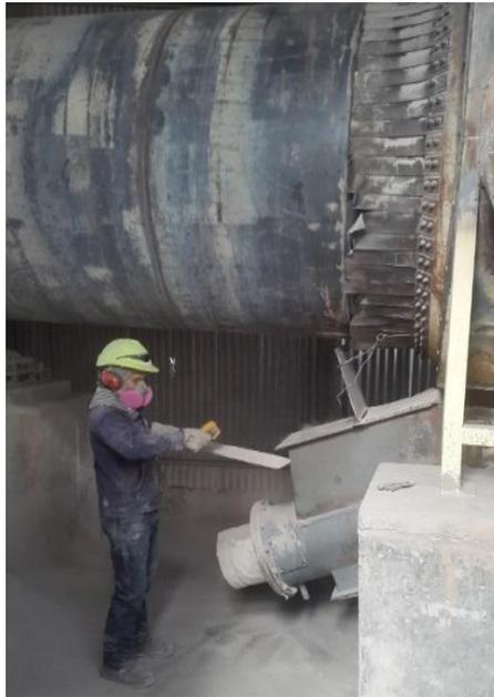
**Figura 3.7. Método de medición de temperatura antes de la implementación del tablero de control.**
