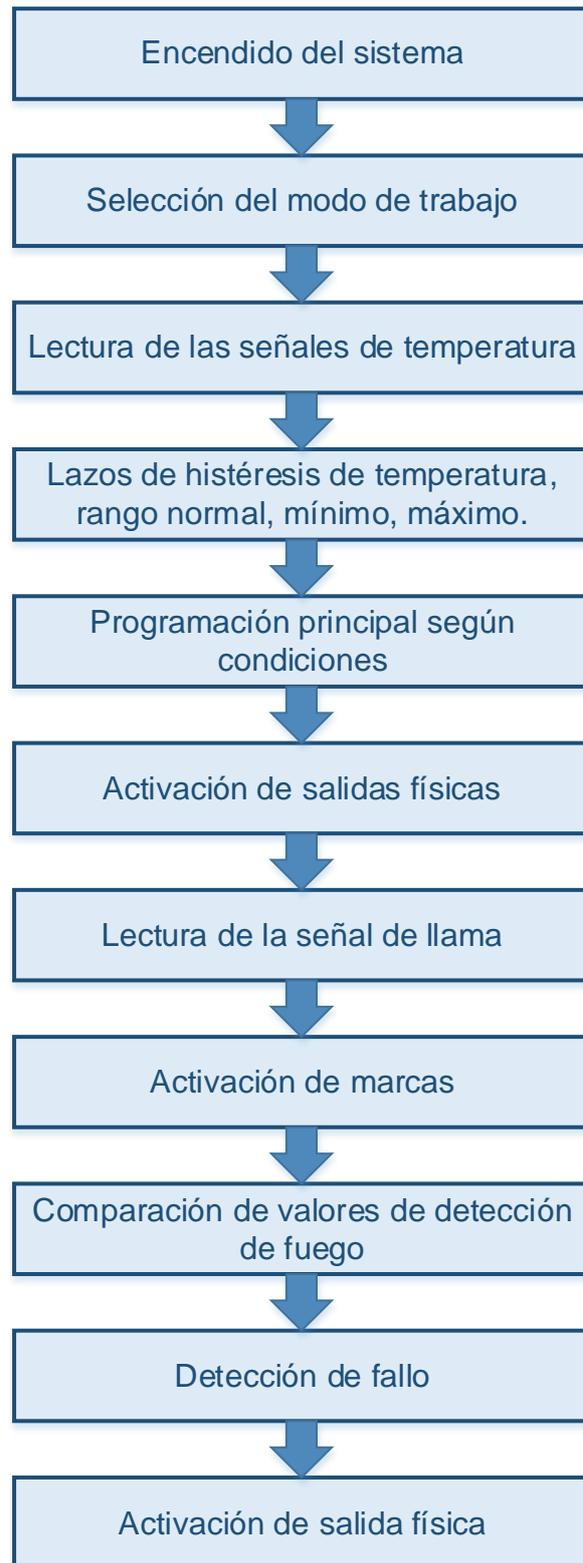
**Figura 2.59. Bloques de programa del PLC**
