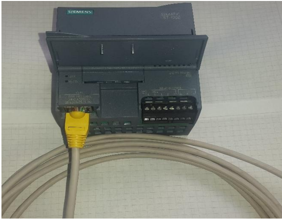
Figura 10: Puerto Ethernet en el PLC S7-1200
