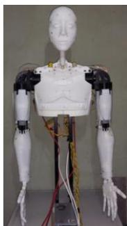
Figura 1. Estructura mecánica robot humanoide.
