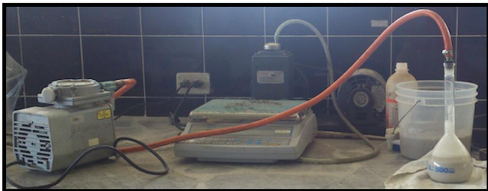
Ilustración 57: Extracción de burbujas de aire del picnómetro con la muestra.
