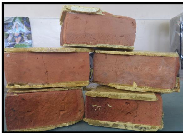
Ilustración 108: Modelo de falla del ladrillo sometido a ensayos de compresión
