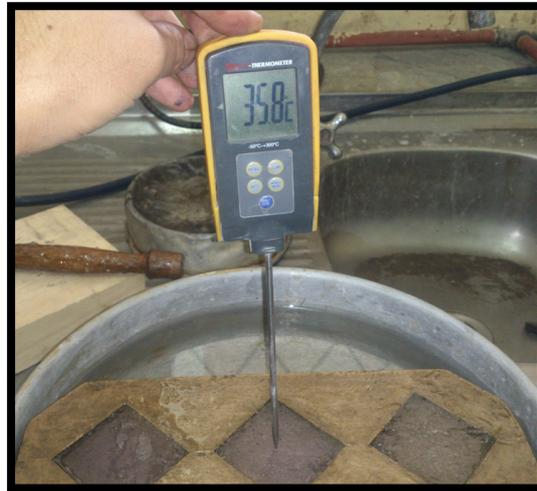
Ilustración 96: Temperatura máxima de fraguado del hormigón con fondo de agua
