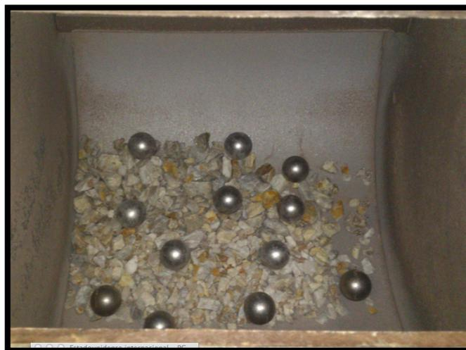
Ilustración 51: Máquina de los Ángeles + material + esferas
