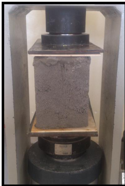
Ilustración 105: Ensayo de Resistencia a la Compresión de un bloque hueco
