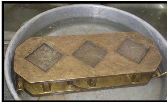
Ilustración 95: Hormigón Traslúcido en proceso de fraguado con fondo de agua
