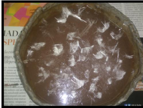
Ilustración 76: Fibras de Vidrio en el hormigón
