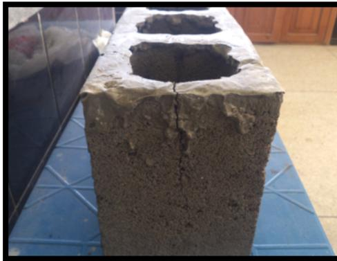
Ilustración 106: Modelo de falla a compresión de los bloques huecos.
