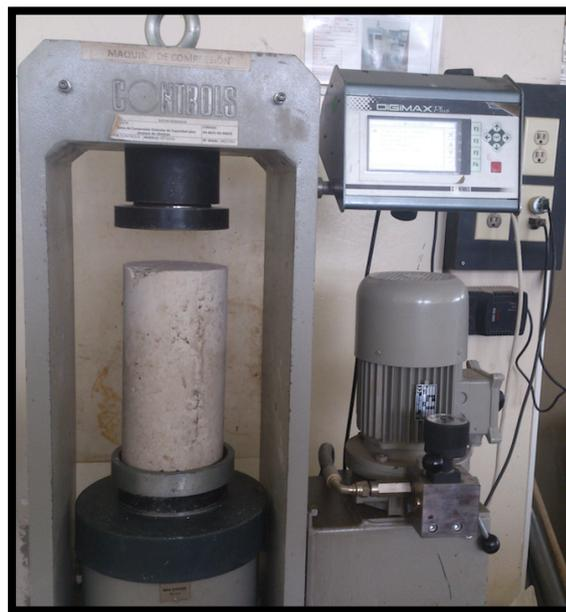
Ilustración 81: Máquina a compresión.
