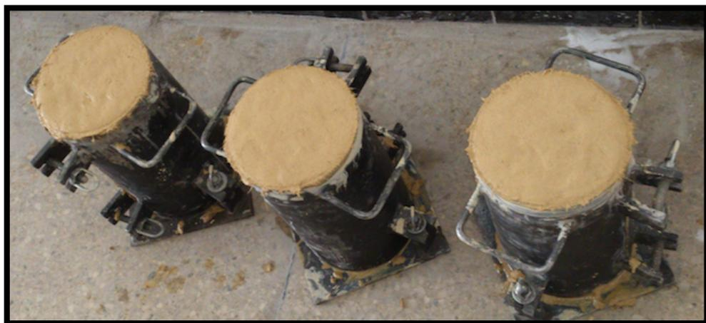
Ilustración 66: Probetas de hormigón.
