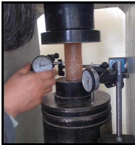
Ilustración 100: Determinación de módulo de elasticidad del hormigón translúcido modificado con resina en máquina de compresión con medidores de deformación.
