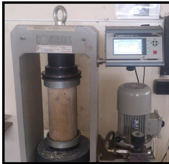
Ilustración 84: Rotura de la probeta en máquina de compresión.
