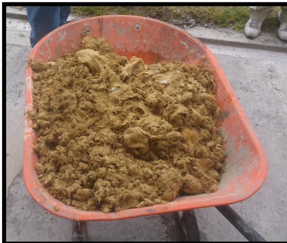
Ilustración 82: Muestra Fallida del Hormigón compuesto con fibras de vidrio.
