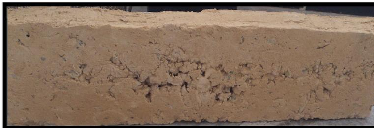
Ilustración 86: Hormigón incorporado resina vinil acrílica en moldes prefabricados
