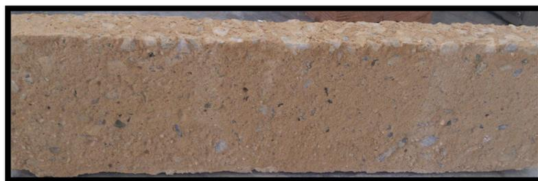
Ilustración 88: Hormigón incorporado emulsión fijadora
