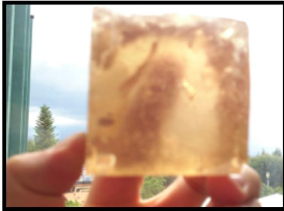
Ilustración 104: Verificación de propiedades ópticas en hormigón modificado con resina.
