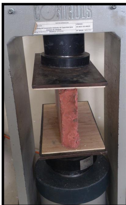
Ilustración 109: Ensayo a compresión del hormigón con Fibras Nylon
