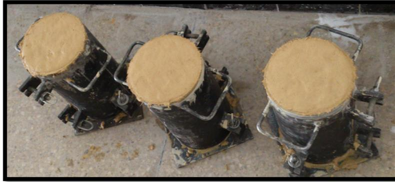
Ilustración 83: Probetas cilíndricas con hormigón incorporado fibras de vidrio
