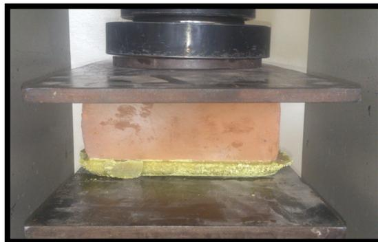
Ilustración 107: Ensayo de ladrillos en la máquina de compresión
