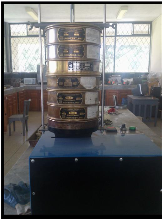
Ilustración 41: Tamizador Vibratorio Eléctrico
