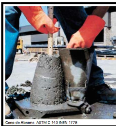
Ilustración 14: Ensayo de cono de Abrams
