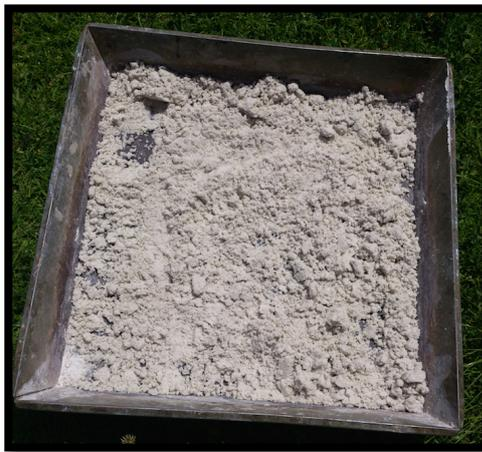
Ilustración 54: Agregado Fino secado
