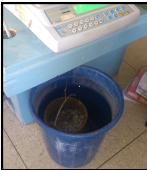
Ilustración 47: Árido sumergido en agua
