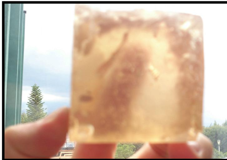
Ilustración 79: Hormigón Translúcido modificado con Resina.
