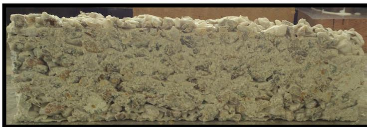
Ilustración 85: Hormigón incorporado Resina vinil acrílica y arena Sílica blanca
