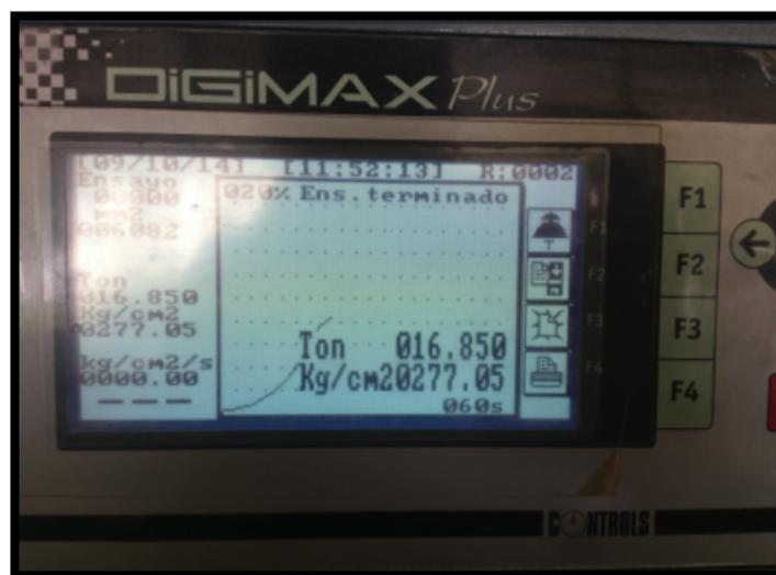
Ilustración 92: Resistencia característica del hormigón a los 28 días.
