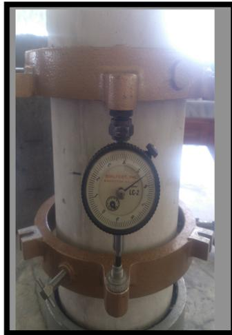
Ilustración 98: Probeta con medidores de deformación vertical
