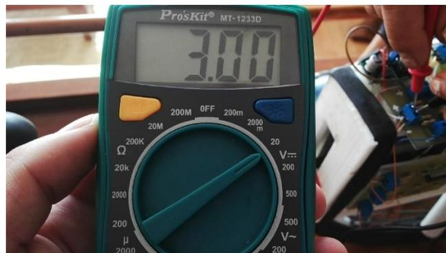
**Figura 177. Voltaje Alimentación Circuito 2**
