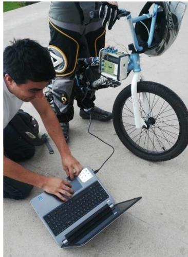
**Figura 187. Conexión Data Logger-PC**
