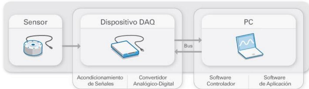
**Figura 128 Sistema de Adquisición de Datos DAQ**
