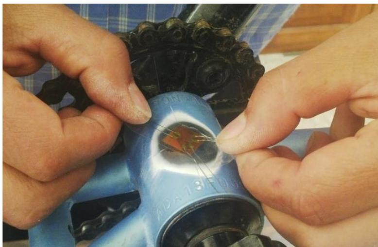
**Figura 156. Fijación del Sensor**
