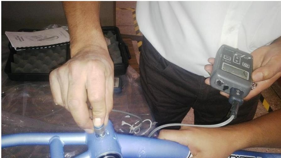
**Figura 102. Medición de espesores en los alojamientos**
