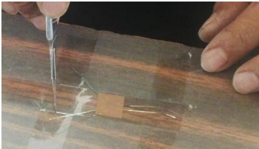
**Figura 155. Sujeción de la Roseta en una Cinta**
