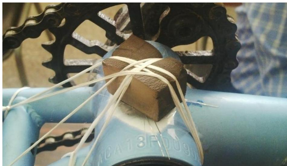
**Figura 157. Fijación Temporal para el secado del adhesivo**
