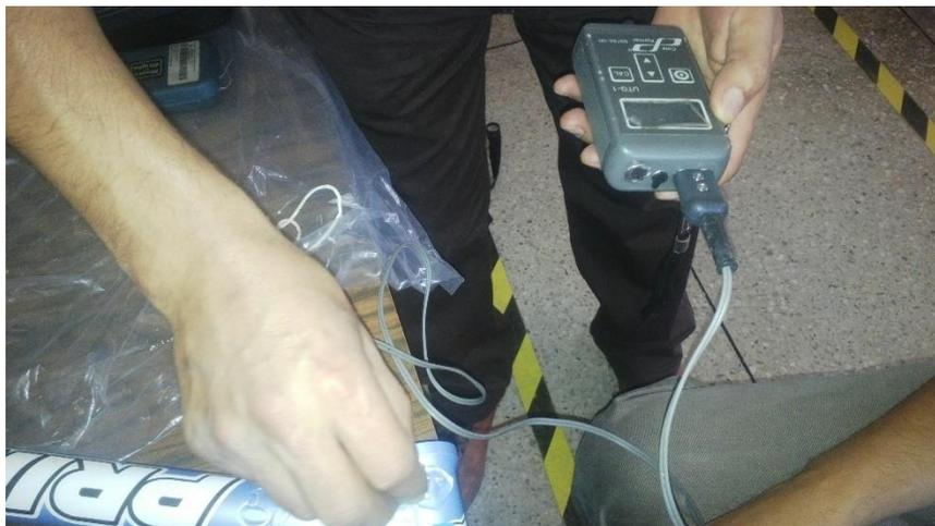
**Figura 101. Medición de espesores del tubo A**
