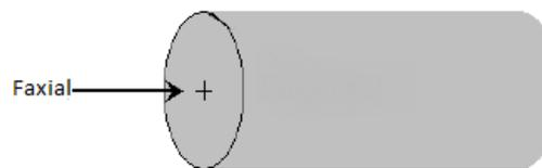
**Figura 9. Fuerza Axial aplicada al Área Transversal de un Cilindro**
