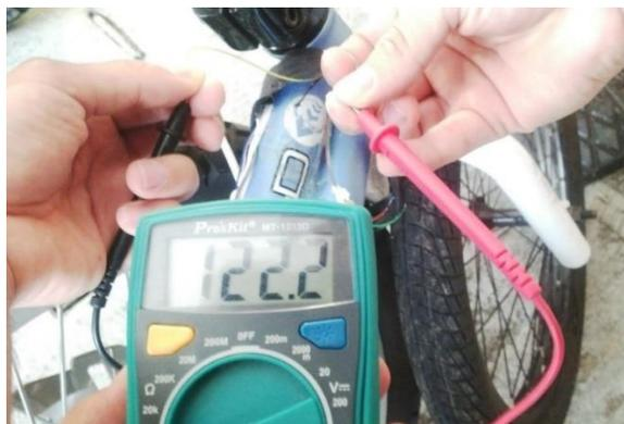
**Figura 175. Medición de Resistencia en los sensores**
