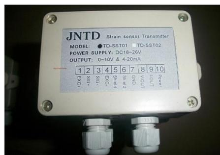
Figura 91. Amplificador de Señal
