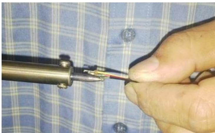
**Figura 161. Fusión de los Alambres sueltos del Cable**
