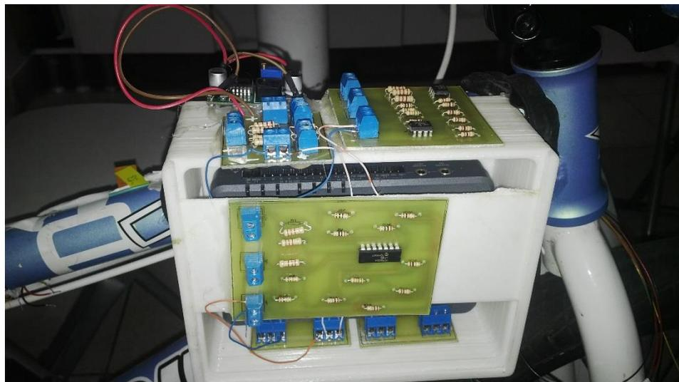
**Figura 173. Ubicación Circuitos Puente-Amplificador y Regulador Voltaje**
