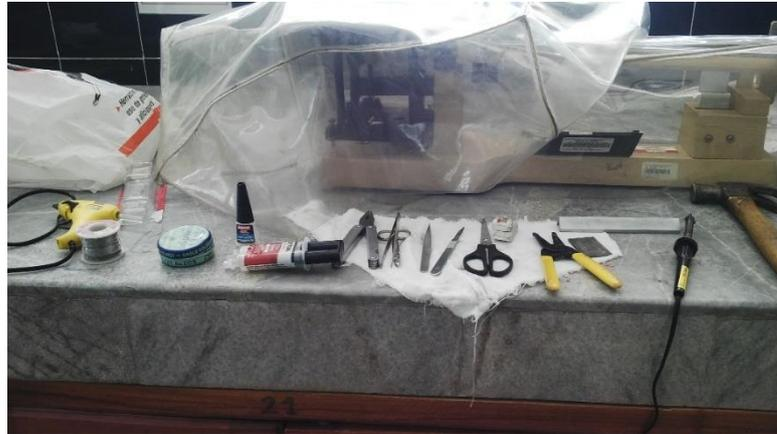
**Figura 154. Insumos y Herramientas para colocar las galgas**
