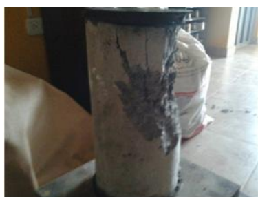
Figura 44. Refrendado con capping falla tipo cónica y transversal.
