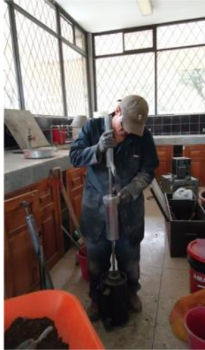
Figura 25. Compactación utilizando el martillo de Proctor Modificado de 12”.
