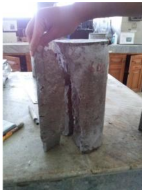
Figura 49. Falla tipo columnar.
