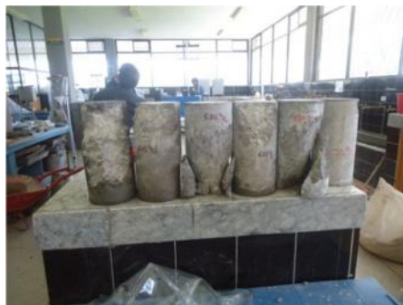
Figura 64. Tipos de falla transversal, cónica dividida, cónica transversal.
