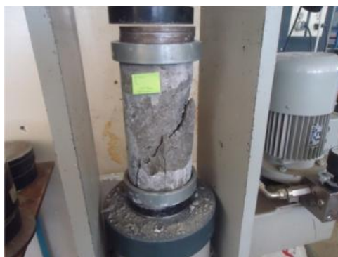
Figura 48. Falla tipo cónica y transversal.
