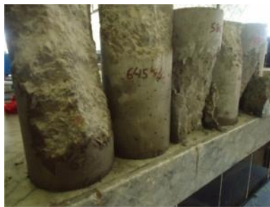
Figura 63. Fallas tipo (transversal, cónica dividida, columnar y cónica transversal).
