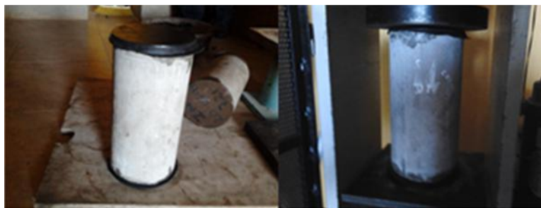
Figura 35. Colocación de la probeta HAD con capping en la máquina de compresión simple.
