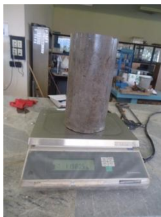
Figura 33. Medición del peso del espécimen de HAD.
