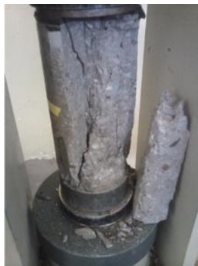
Figura 53. Falla tipo columnar.
