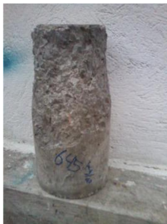
Figura 65. Falla tipo transversal.
