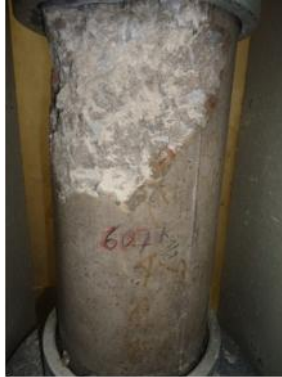
Figura 62. Falla tipo transversal.
