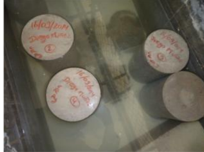
Figura 30. Colocación del espécimen en la piscina de curado.
