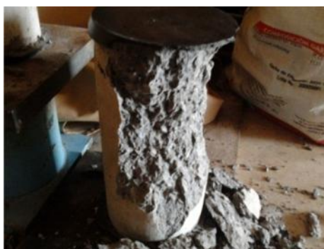
Figura 47. Falla tipo columnar.
