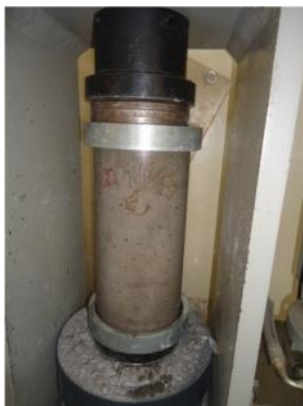
Figura 36. Colocación de la probeta AHD con almohadillas de neopreno en la máquina de compresión simple.
