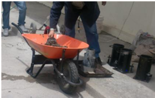
Figura 20. Mezcla previa antes de colocación en los moldes.
