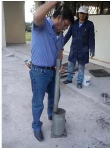
Figura 24. Compactación utilizando el martillo de Proctor Modificado de 2”.
