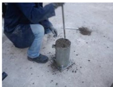
Figura 22. Compactación de la mezcla de hormigón.
