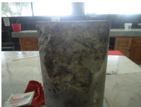
Figura 59. Falla tipo transversal.
