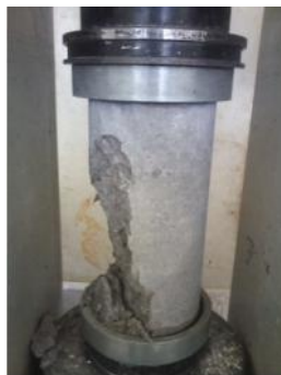
Figura 56. Falla tipo columnar.
