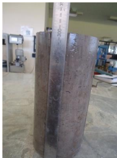
Figura 31. Medición de altura del espécimen de HAD.
