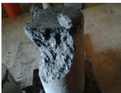
Figura 45. Falla tipo transversal.
