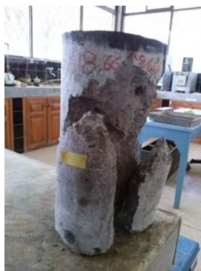
Figura 50. Resistencia a la compresión 618 Kg/cm 2 falla tipo cónica dividida.
