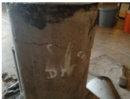
Figura 46. Falla tipo a.
