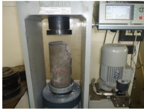
Figura 38. Probeta de HAD después del ensayo a compresión.
