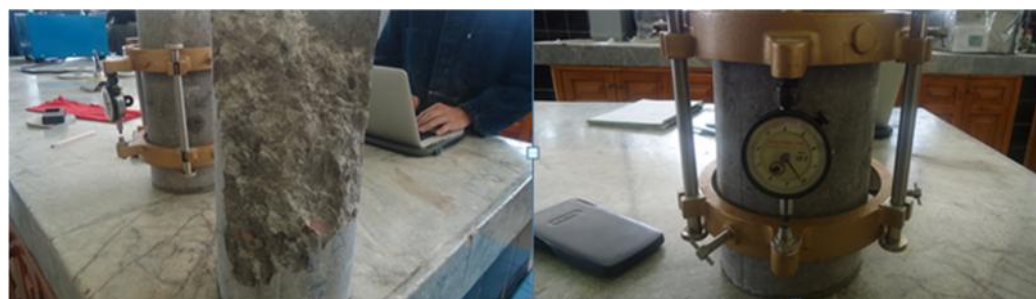
Figura 66. Módulo de elasticidad del hormigón con falla tipo transversal y resistencia a la compresión de 645 Kg/cm 2
