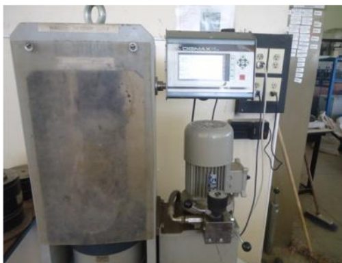
Figura 37. Aplicación de carga en la probeta de HAD.
