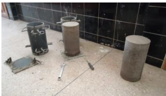
Figura 28. Desencofrado del HAD.
