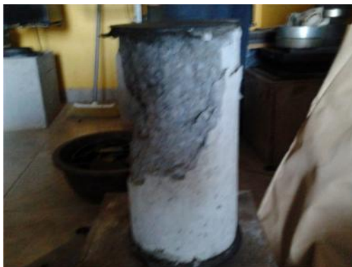
Figura 41. Refrendado con capping, falla tipo transversal
