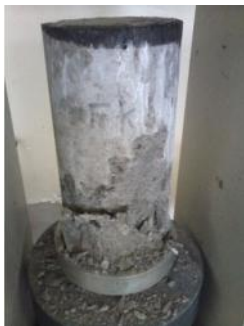
Figura 54. Falla tipo transversal.
