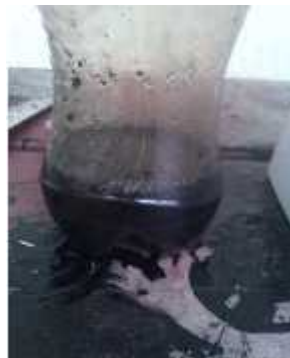
Figura 22. Medición de alquitrán producido en la gasificación
