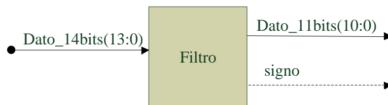
Figura 25. Diagrama RTL del decodificador de pesos.
