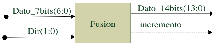
Figura 23. Diagrama RTL de la fusión de paquetes Lsb con Msb.
