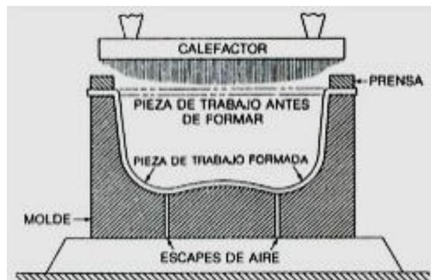
**Figura 2. 5 Proceso de termoformado**
