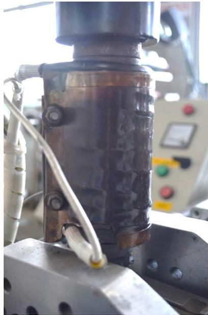
**Figura 3. 38 Resistencia de la máquina**
