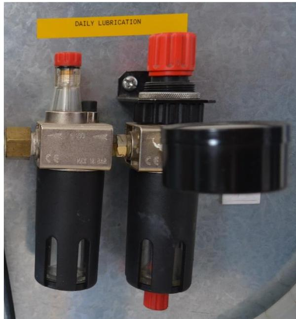
**Figura 3. 42 Unidad de mantenimiento neumático FRL**
