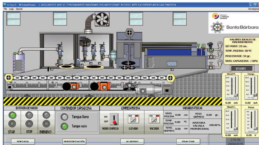
**Figura 112. Interfaz gráfica HMI de la planta industrial automática de gas pimienta.**
