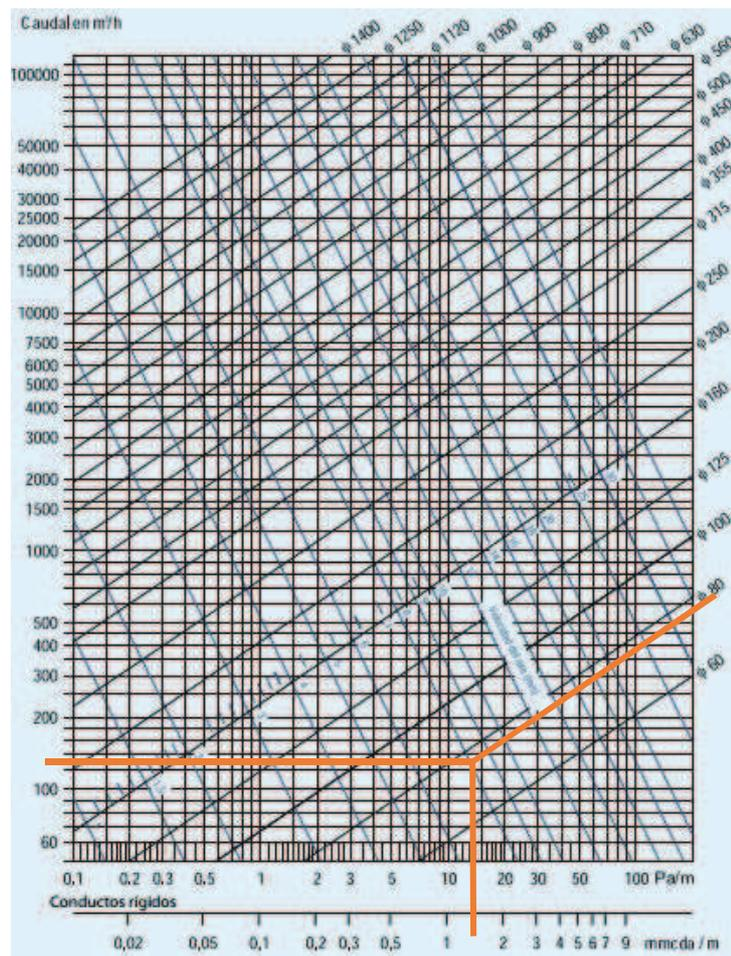
**Figura 29. Selección de diámetro del conducto.**
