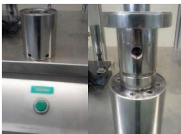
**Figura 1. Máquina neumática llenadora de líquidos. (Equipo desarmado)**
