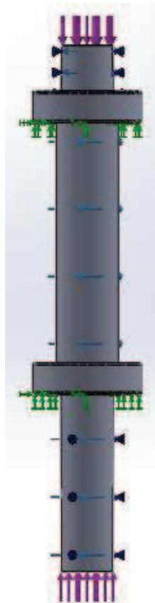
**Figura 16. Cargas aplicadas al eje de transmisión.**
