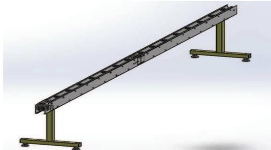
**Figura 80. Ensamble total de la banda transportadora.**
