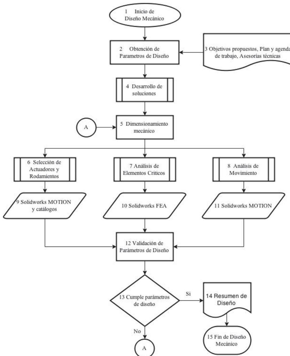
**Figura 9. Modelo de Diseño Mecánico**
