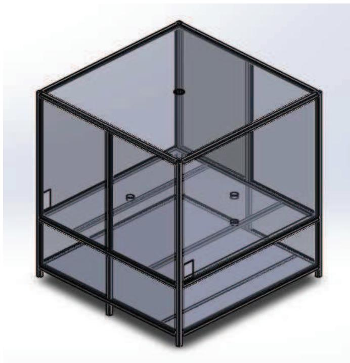
**Figura 27. Estructura de cabina hermética.**
