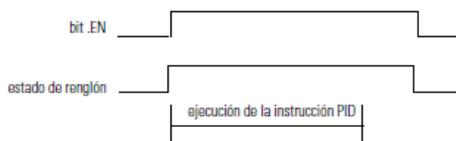
**Figura 105. Señal Funcionamiento de la señal PID en el bit. EN.**
