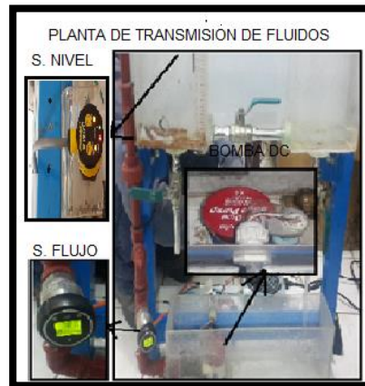
Figura 99 Planta de transmisión de fluidos
