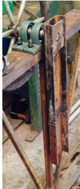
Figura 45. Parante de sujeción a cuerpo de horno perfil C
