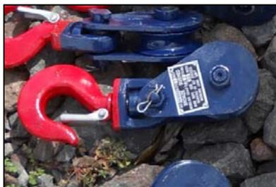
**Figura 101.** Poleas arreglo longitudinal diámetro 3'' y capacidad 2 toneladas
