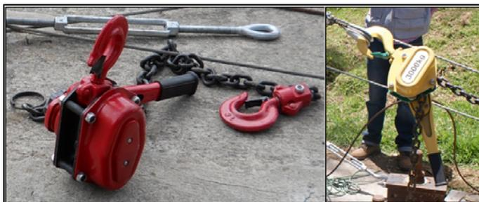
**Figura 95.** Tecles de carga de capacidad 3000 kg
