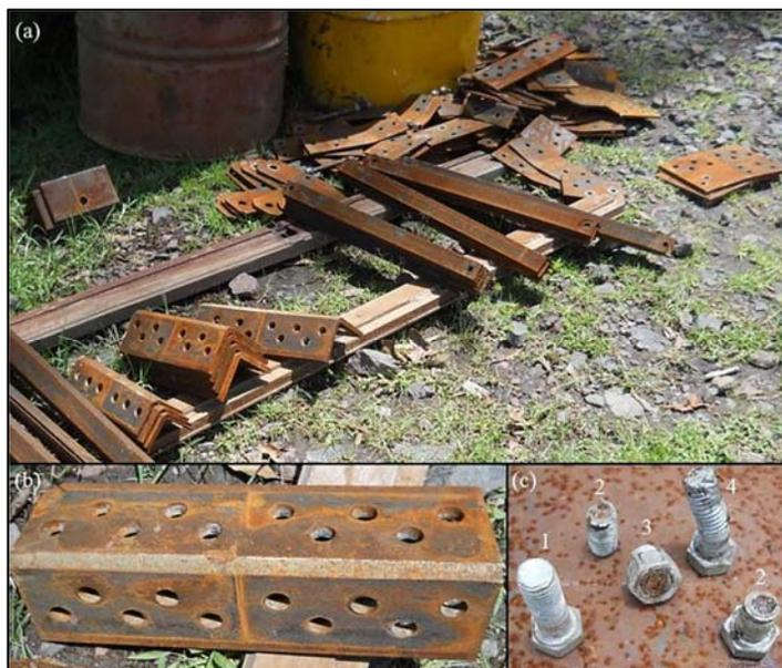
**Figura 138.** Placas de interés desmontadas y pernería; (a) Placas interiores y principales; (b) Placa interior de unión más crítica a compresión y (c) pernos de acuerdo a condición de desmontaje
