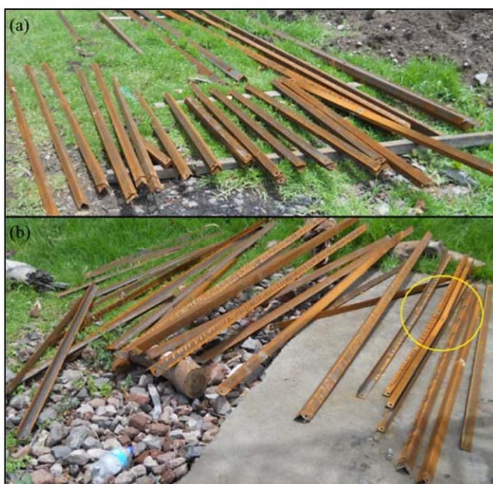
**Figura 136.** Clasificación elementos de Tramo 7; (a) Tramo 7 y (b) celosía y antitorsos Tramo 7, señalados elementos deformados
