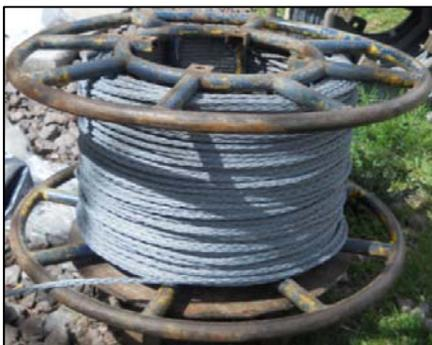
**Figura 94.** Cable para aplicación de carga en torre a prueba.
