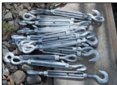
**Figura 96.** Tensores de 3 toneladas de capacidad tipo Ojo-Gancho
