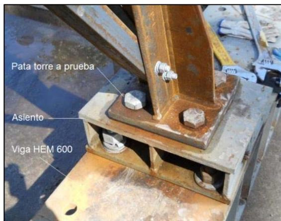
**Figura 30.** Asiento para pata de torre a prueba.
