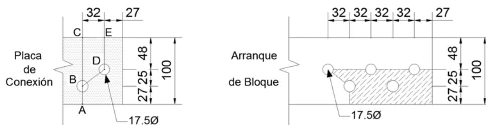
**Figura 58.** Sección de corte en placa de conexión
