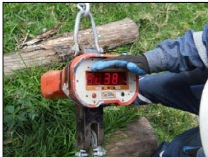
**Figura 99.** Dinamómetro digital de 5 toneladas de capacidad
