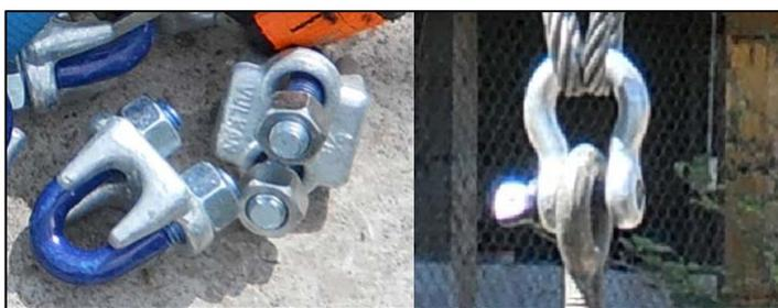
**Figura 103.** Grilletes y U de montaje respectivamente
