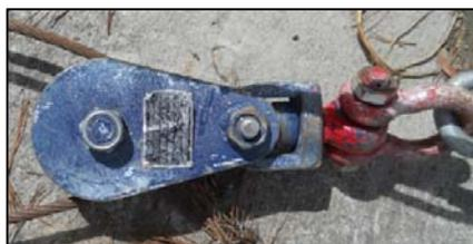
**Figura 102.** Polea de anclaje diámetro 4 ½'' y capacidad 4 toneladas
