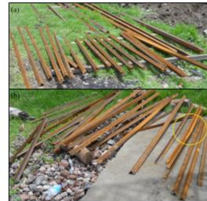
Figura 136. Clasificación elementos de Tramo 7; (a) Tramo 7 y (b) celosía y antitorsos Tramo 7, señalados elementos deformados
