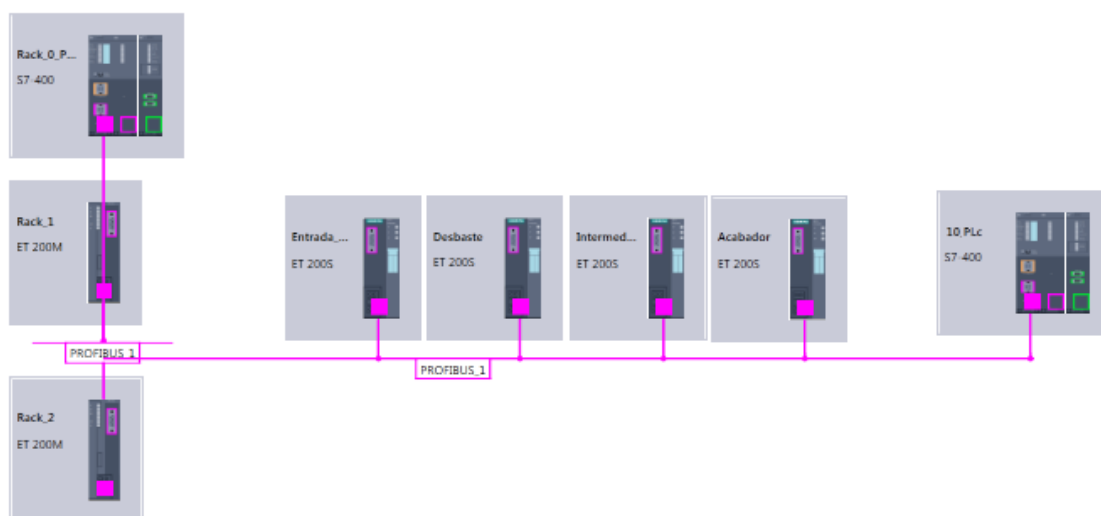
Figura 5.5.- Diagrama de red PLC - PML's. (Obtenido de Tia tool selection).
