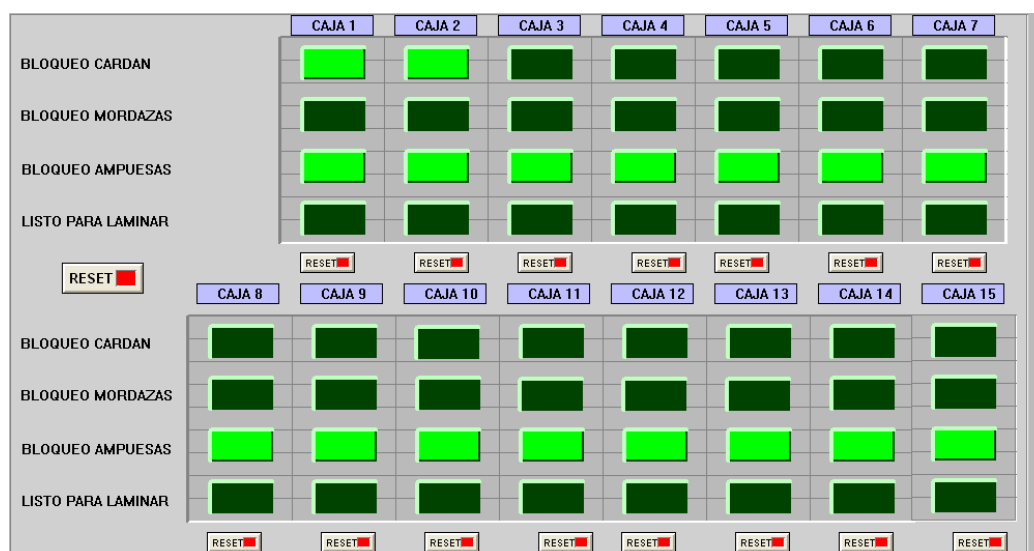
Figura 8.16.- Pantalla Movimientos Hidráulicos cajas 1-15.
