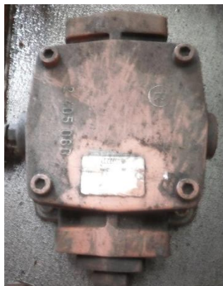
Figura 3.7.- Filtro de retorno de sistema hidráulico.
