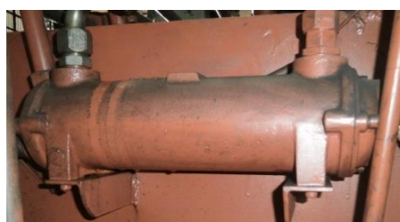
Figura 3.5.- Intercambiador de calor del sistema hidráulico.
