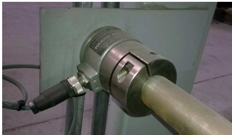
Figura 93 Celda de Carga Sujeta a la Placa
