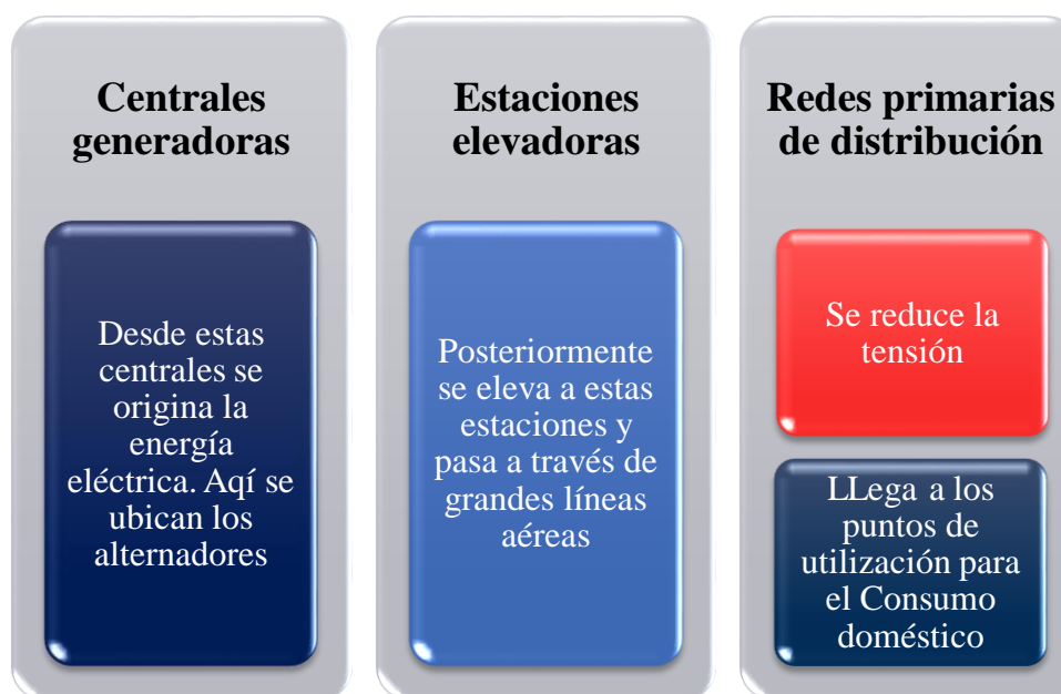
Figura 7. Sistemas eléctricos Fuente: (Carrasco , 2008)
