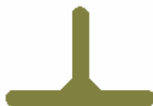
Figura. 1.7. Robustez Física para la Pista Mediante un Chaflán
