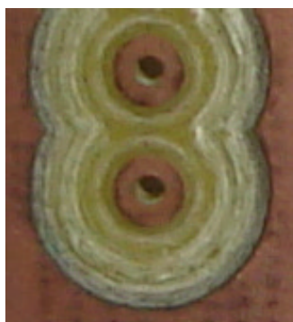
Figura 5.8. Acción de una Fresa tipo T con una Fuerza de Solenoide Sobredimensionada
