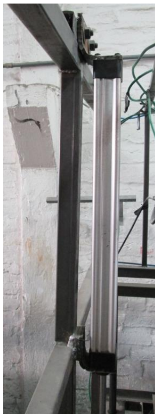
Figura 77 Sujeción del cilindro neumático a la estructura
