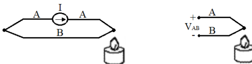
Figura 19 Esquema de una termocupla
