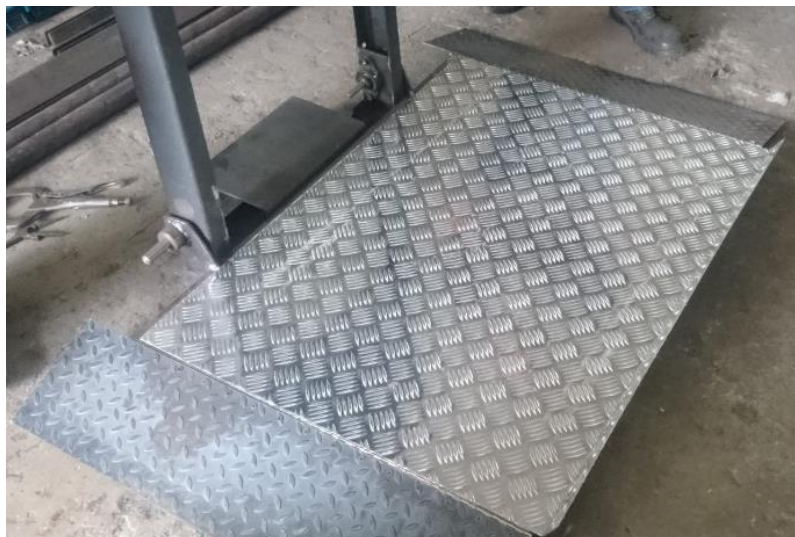
Figura 94. Cubierta y rampas de acceso.
