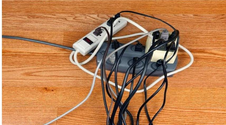
**Figura 98 Vista de una sobrecarga en una regleta.**
