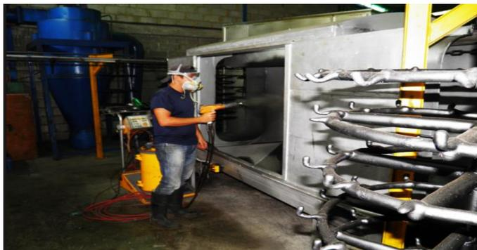
**Figura 7 Vista de la ejecución de un pintado con pintura electrostática.**
