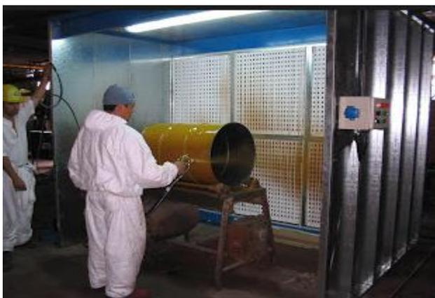
**Figura 3 Cabina tipo seco**
