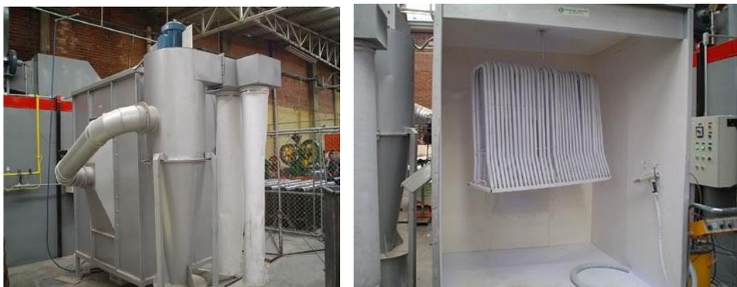
**Figura 2 Cabinas de pintura tipo ciclónica**
