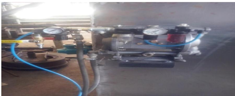
**Figura 116 Conexión neumática de la bomba de diafragma.**
