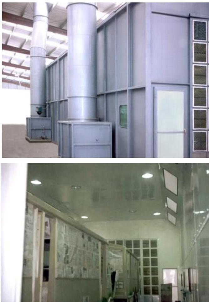
**Figura 4 Cabinas de pintura tipo semi-húmedas**
