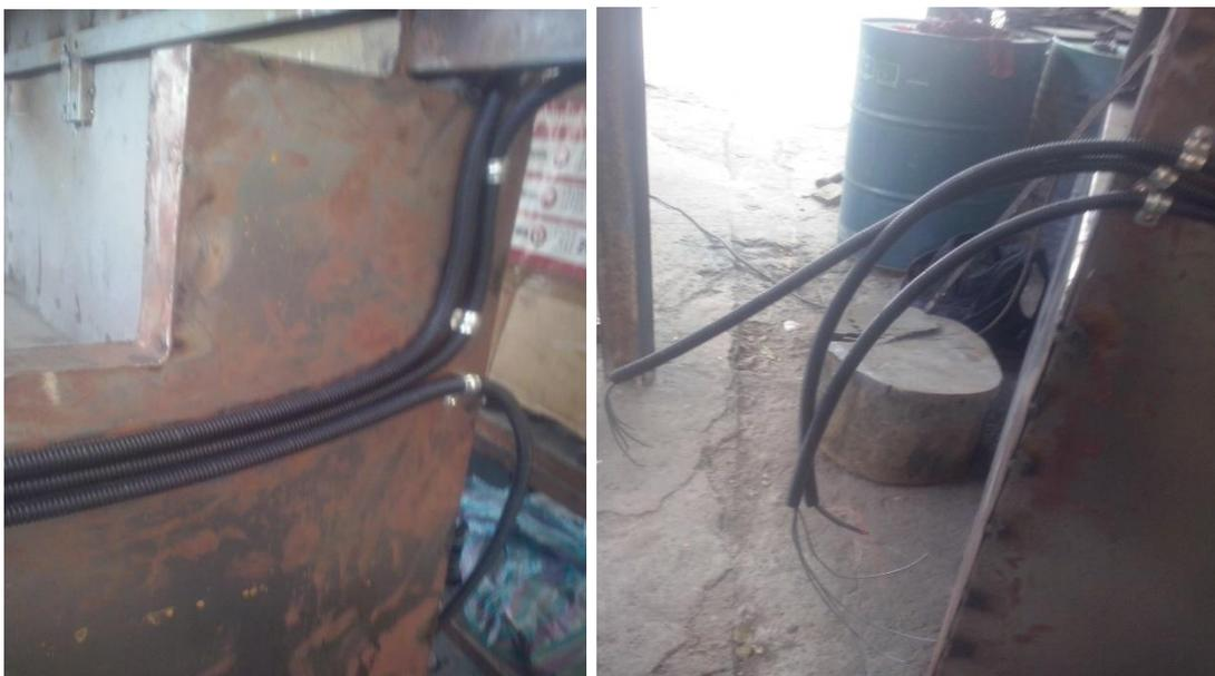
**Figura 122 Distribución de mangueras alrededor de la máquina.**
