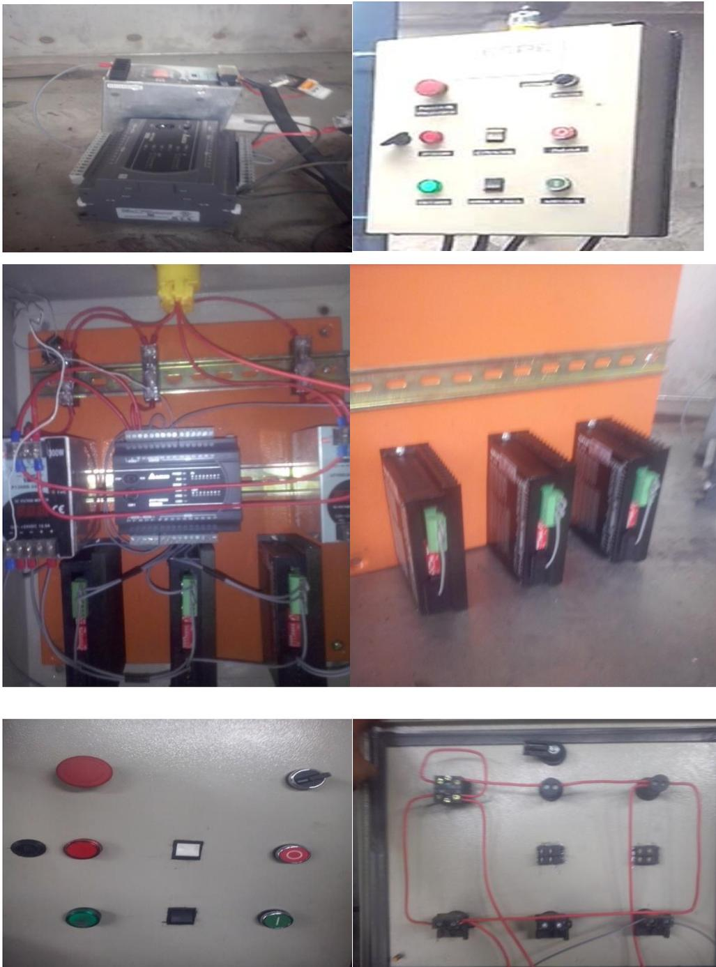
**Figura 123** Diferentes vistas del cableado del tablero de control.
