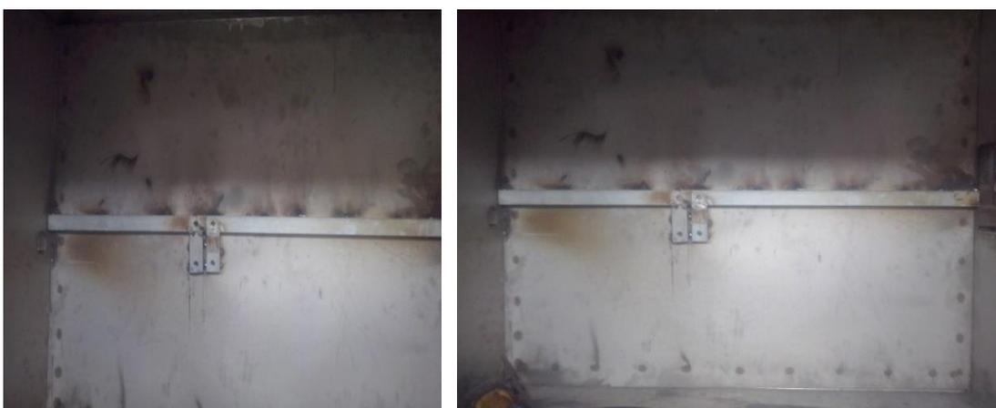
**Figura 105 Base para colocación de tornillos sin fin.**
