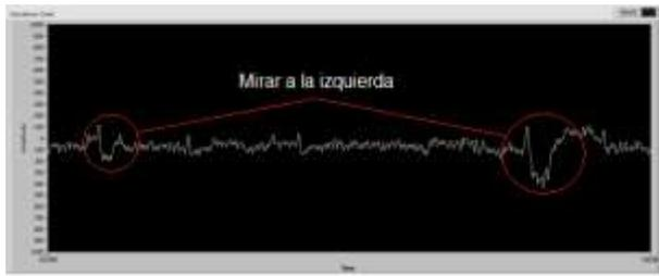
Fig. 9 Forma de onda al mirar hacia la izquierda en Labview
