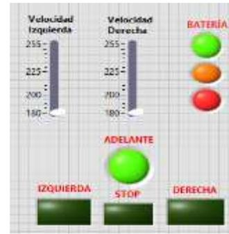
Fig. 4 Interfaz del estado de la silla de ruedas en Labview
