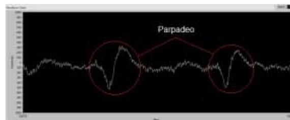
Fig. 8 Forma de onda al parpadear en Labview
