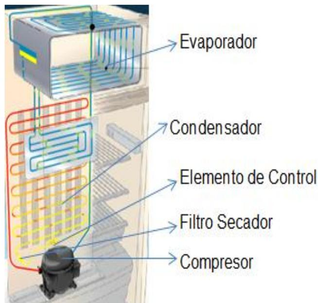
**Figura 29 Sistema de refrigeración**
