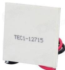
Figura 12. Módulo Peltier (TEC1-12715).
