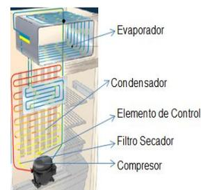
Figura 13: Esquema del Sistema de Refrigeración.
