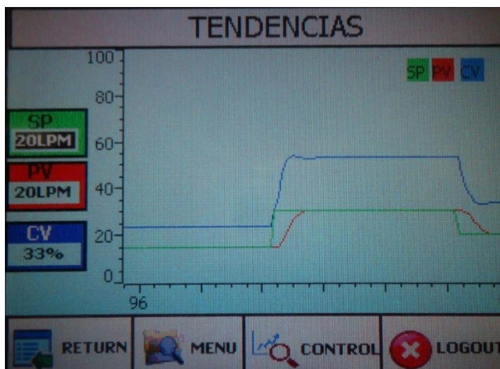
Figura 126: Tendencias del proceso con K_p=1.001 , T_i=2,43 y T_d=0,014
