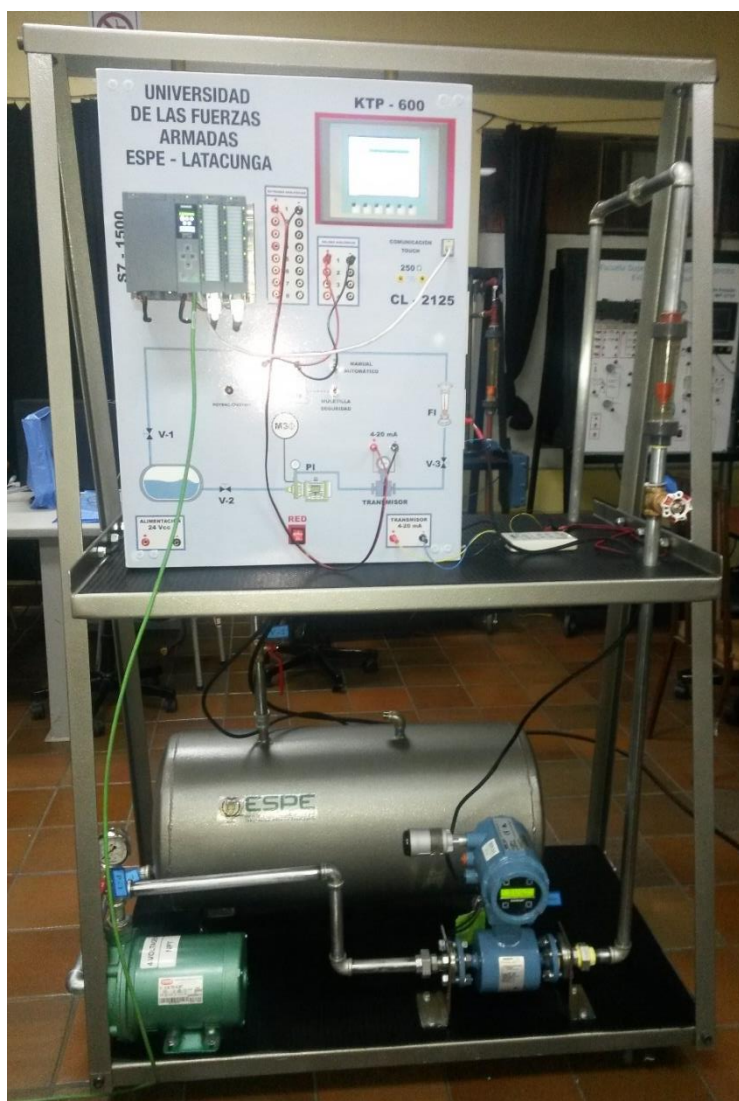
Figura 113: Estación de Caudal
