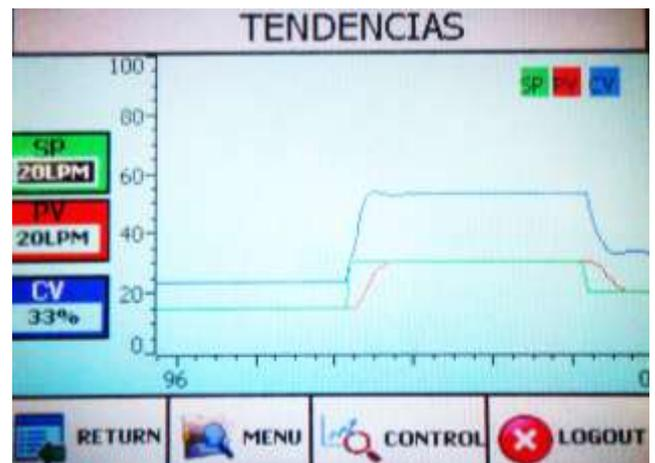
Figura 13: Respuesta del sistema frente a un cambio de SP de 15 LPM a 30 LPM y 20 LPM
