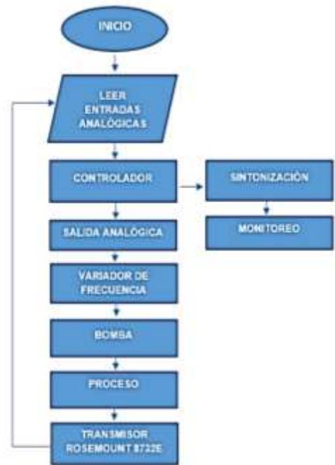
Figura 9: Diagrama de flujo del proceso
