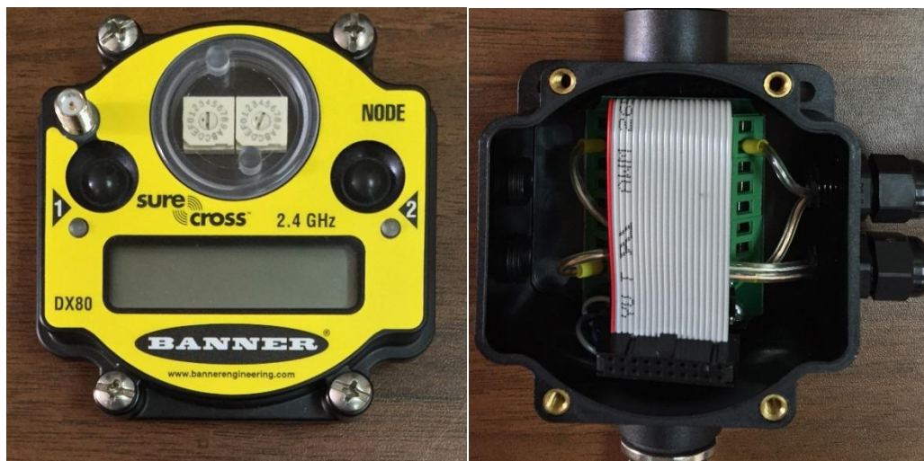
Figura 28: Desmontaje de la cubierta superior del Nodo
