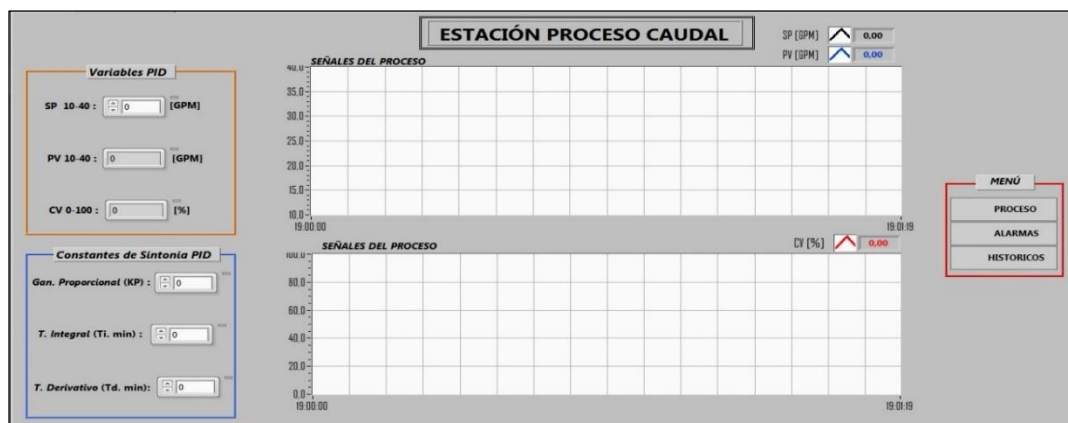
Figura 55: Sintonía del proceso caudal
