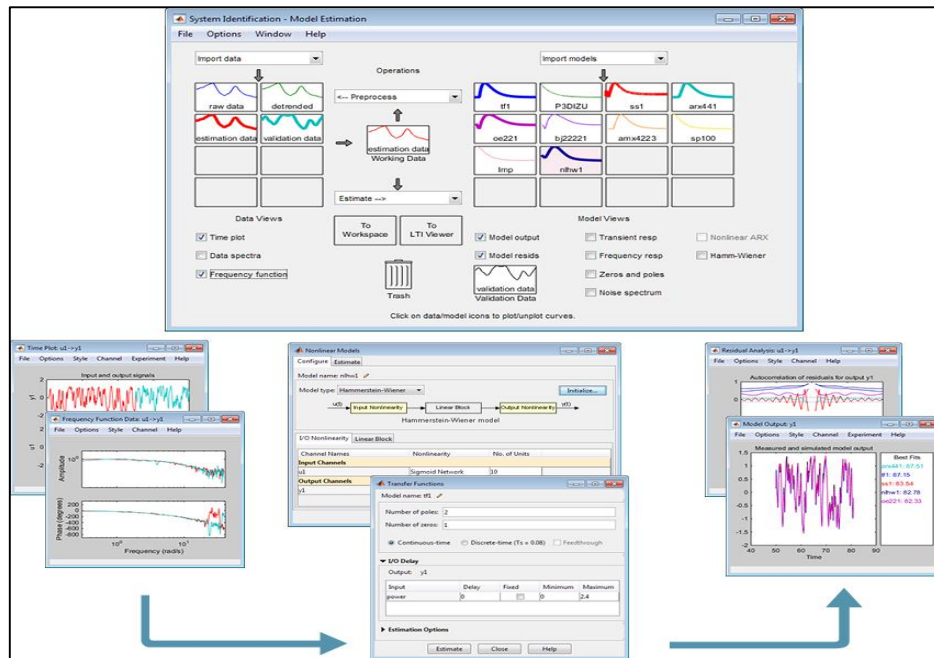
Figura 21: Sistema de identificación utilizando Toolbox (parte superior), analizar e importar datos reprocesados (izquierda), estimación de los modelos lineales y no lineales (parte inferior), validar modelos estimados (derecha).
