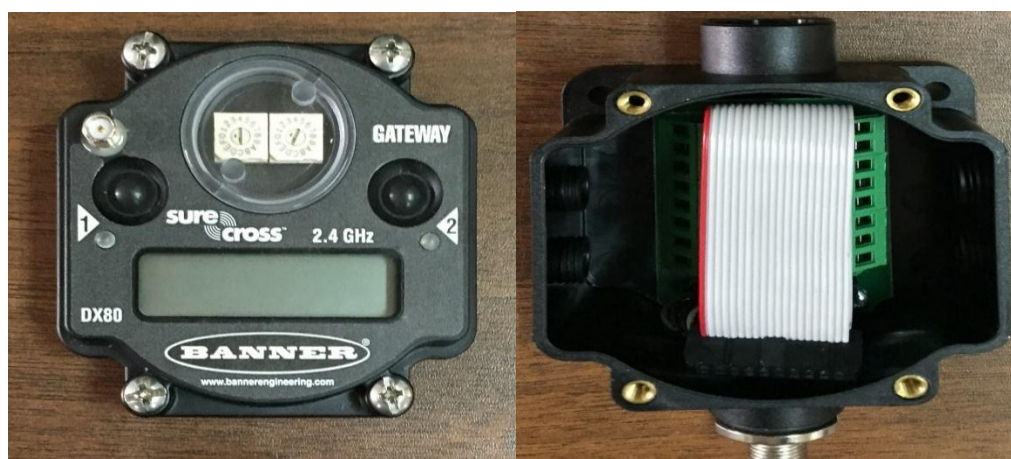
Figura 25: Desmontaje de la cubierta superior del Gateway
