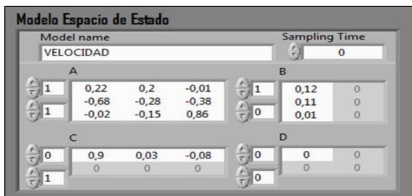
Figura 74: Modelo de la ecuación de estados del proceso velocidad
