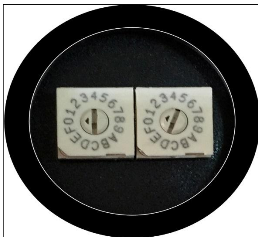
Figura 31: Asignación del ID de red (Dial izquierda) y dirección de dispositivo (Dial derecho)
