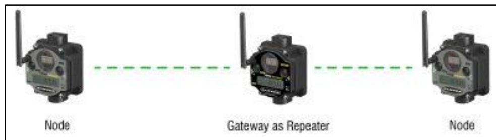
Figura 6: Topología Punto a Punto con Repetidor
